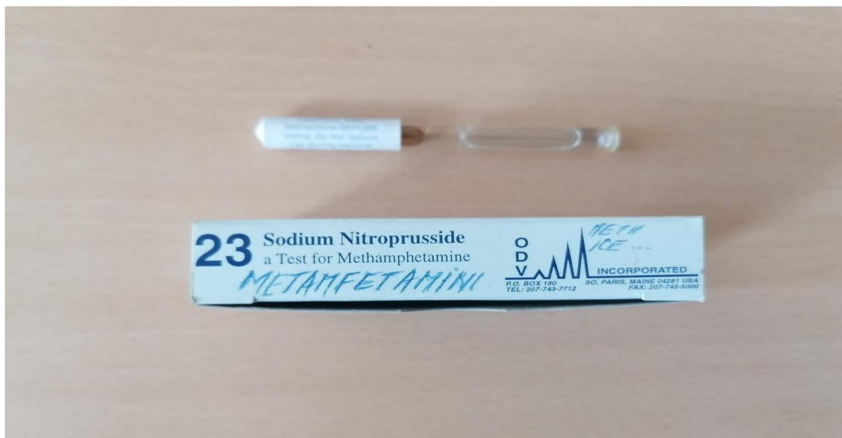
Slika 8 Preliminarni test za Metamfetamin (slikao: vlastiti izvor)
