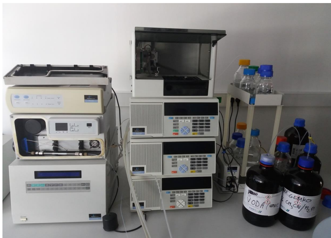
Slika 11. HPLC uređaj korišten za analizu uzoraka
