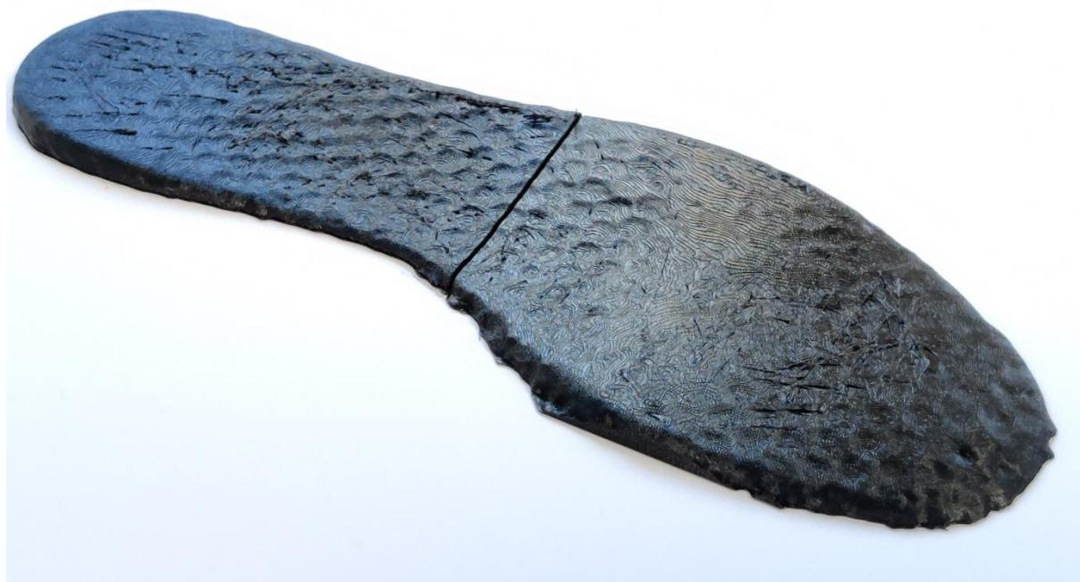
Slika 88. 3D model kompletнog potplata ispisanog na 3D printeru (izvor: autor).
