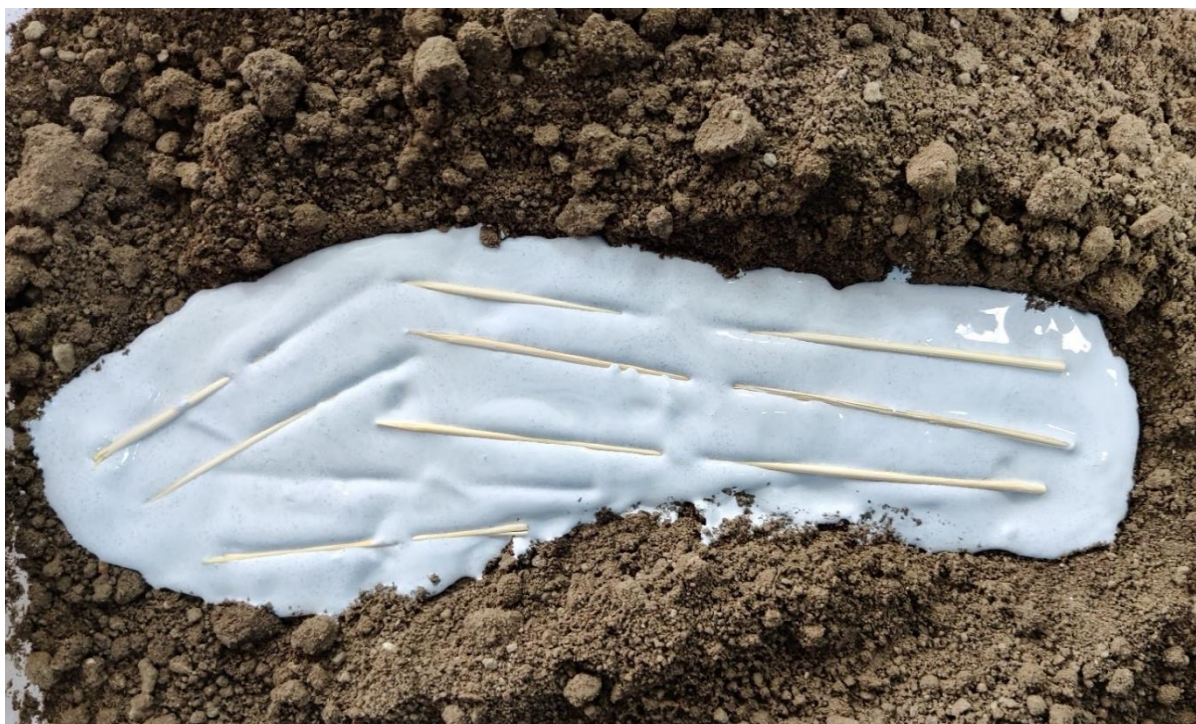
Slika 26. Korak 3. - Ojačavanje strukture odljevka stavljanjem drvenih štapića kao potpore (izvor: autor).
