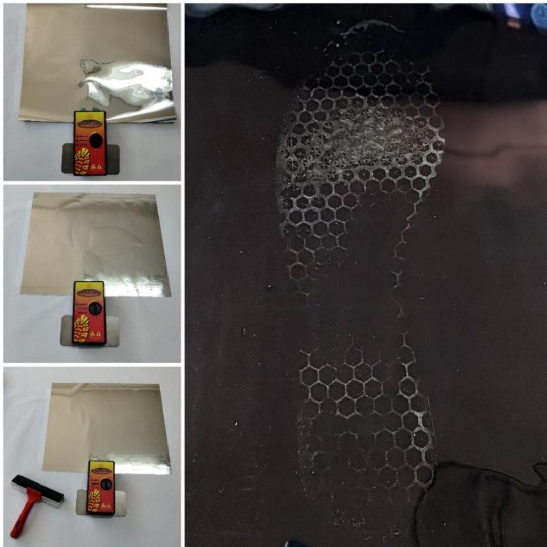
Slika 7. Faze izuzimanja otiska elektrostatskim podizačem i izuzeti trag (izvor: autor).
