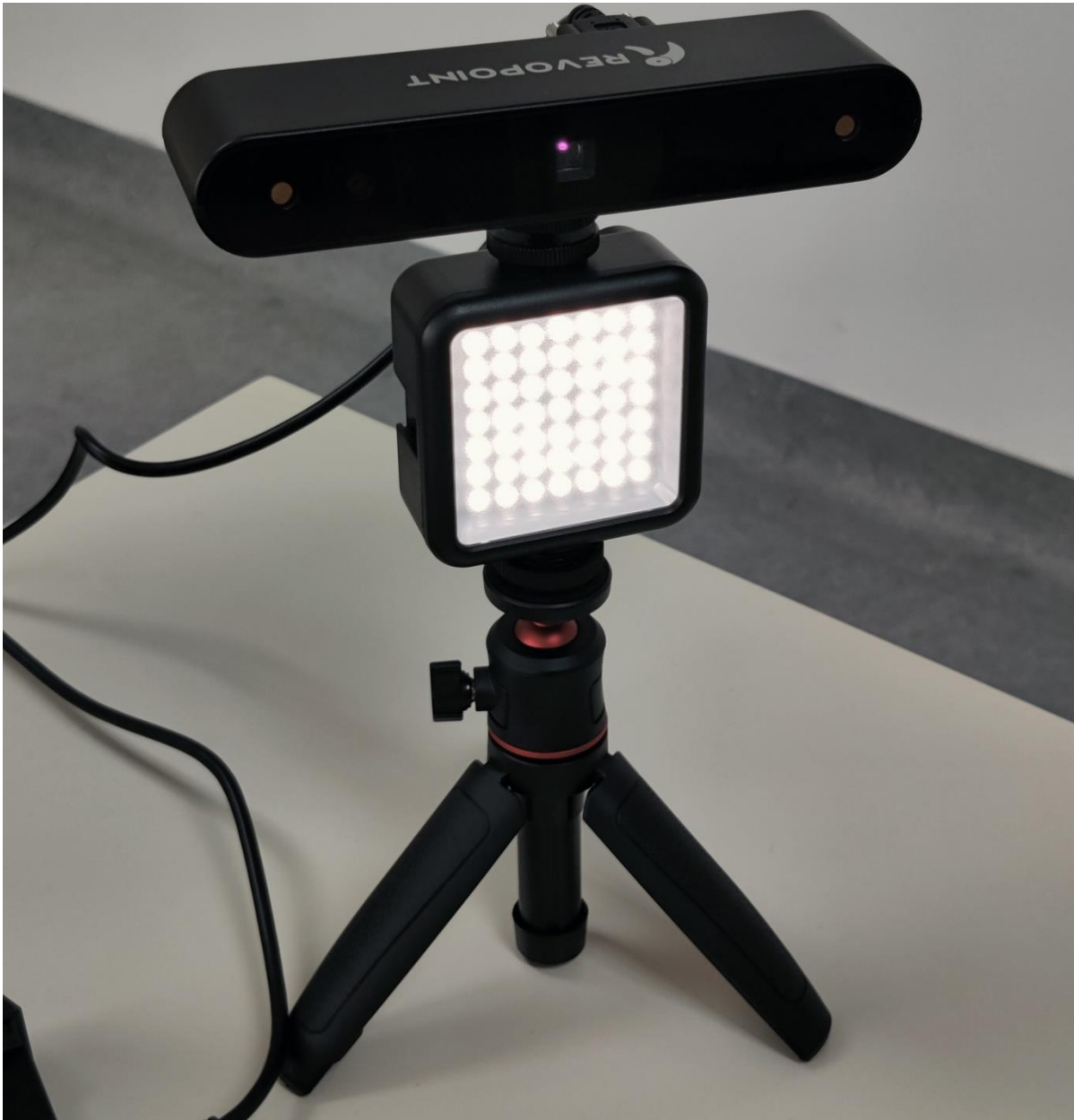
Slika 21. REVOPPOINT POP 3D skener s IR strukturiranim svjetlom (izvor: autor).
