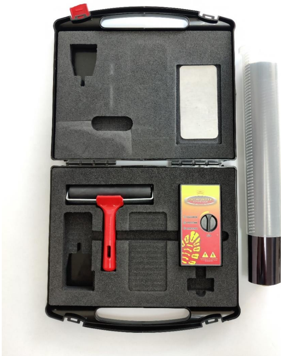
Slika 6. Set za izuzimanje otiska elektrostatičkim podizačem (izvor: autor).
