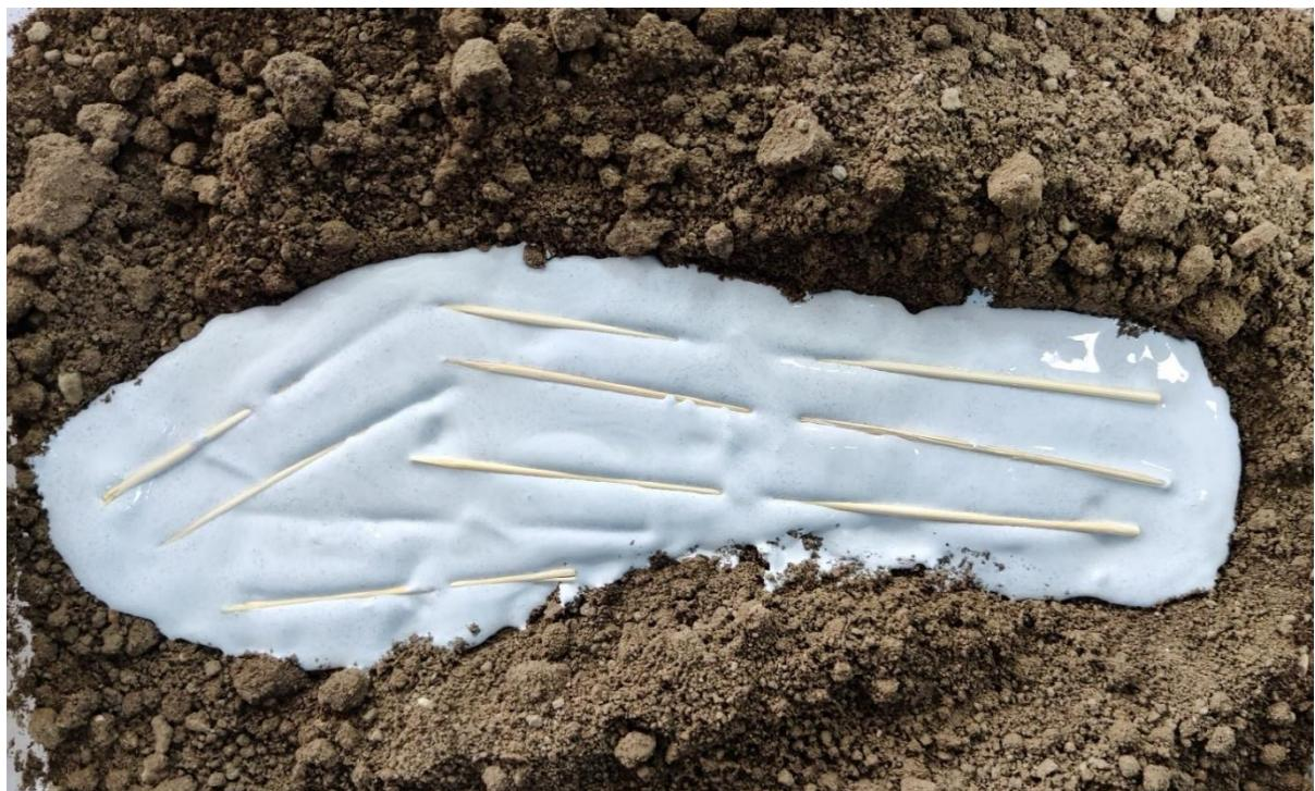
Slika 26. Korak 3. - Ojačavanje strukture odljevka stavljanjem drvenih štapića kao potpore
