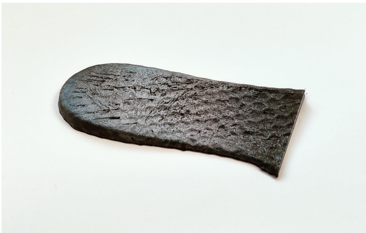
Slika 87. 3D model stražnjeg dijela potplata ispisan na 3D printeru (izvor: autor).
