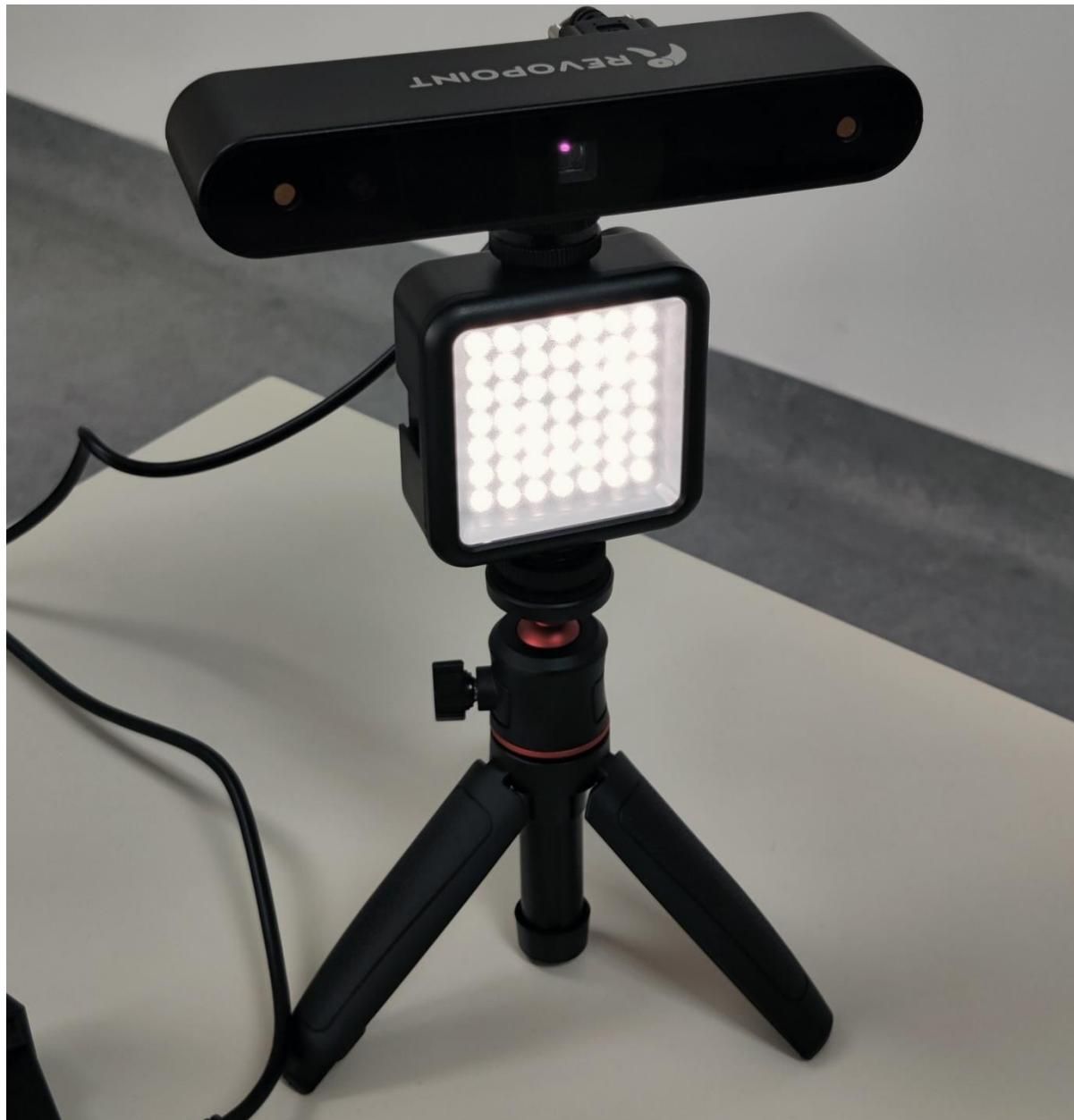
Slika 21. REVOPOINT POP 3D skener s IR strukturiranim svjetlom (izvor: autor).
