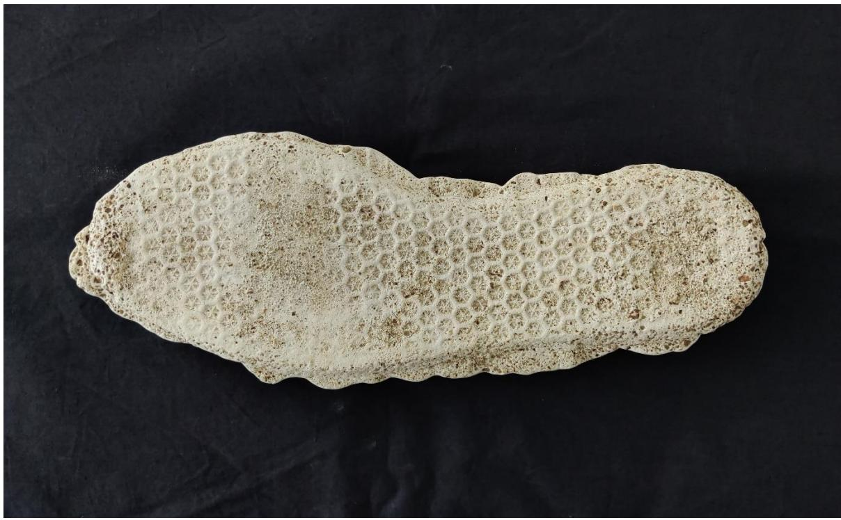
Slika 39. Rezultat mulažiranja nakon sušenja i čišćenja izvedenog odljevka utiska (izvor: autor).
