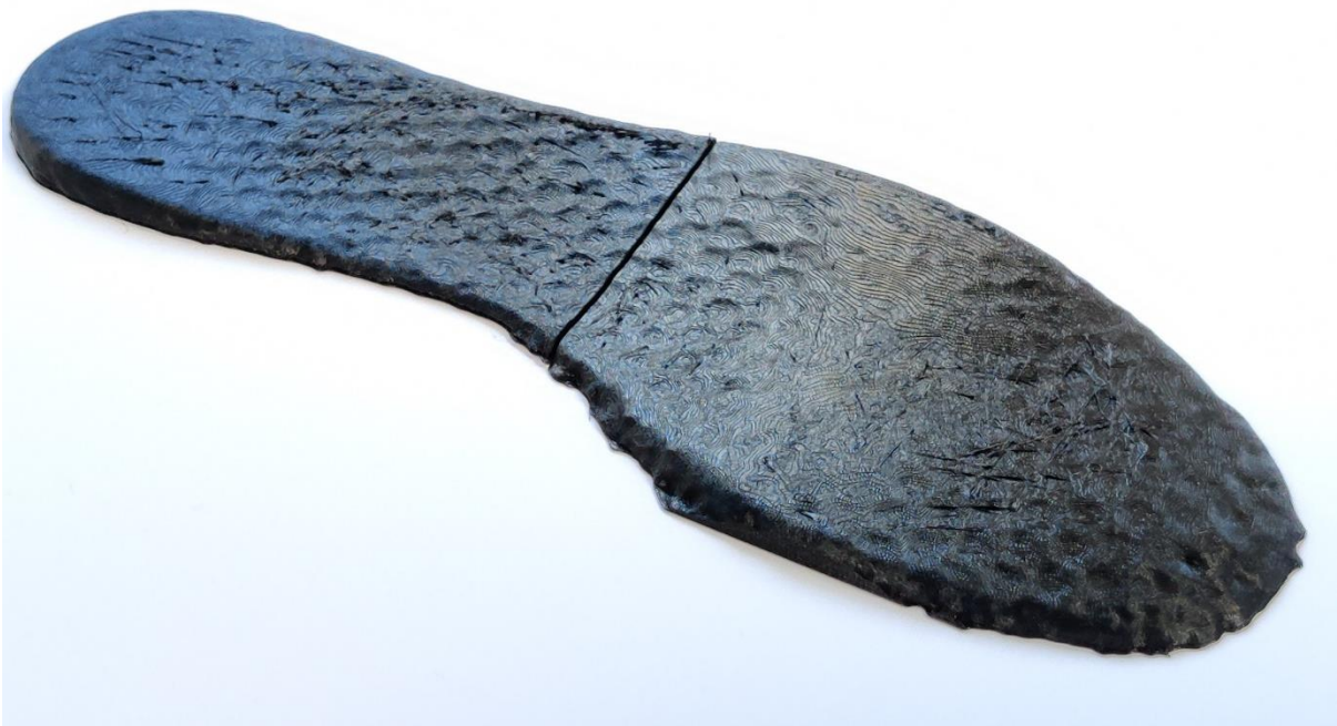
Slika 88. 3D model kompletnog potplata ispisanog na 3D printeru (izvor: autor).
