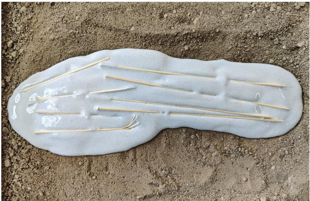
Slika 36. Korak 5. - Ojačavanje strukture odjlevka stavljanjem drvenih štapića kao potpore
