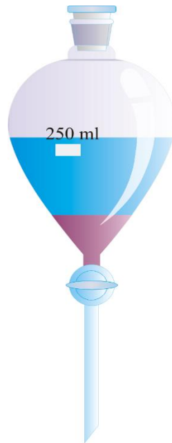
Slika 10. Lijevak za odjeljivanje (23)
