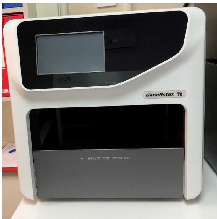
Slika 10. Automatski izolator GeneRotex 96 (izvor: NZJZ)
