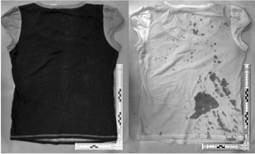
Slika 2: Vizualiziranje tragova krvi na tamnim podlogama – standardna i IC fotografija ( https://www.fujifilmusa.com/products/digital_cameras/x/fujifilm_x_t1_ir/index.html - 15.12.2019.)
