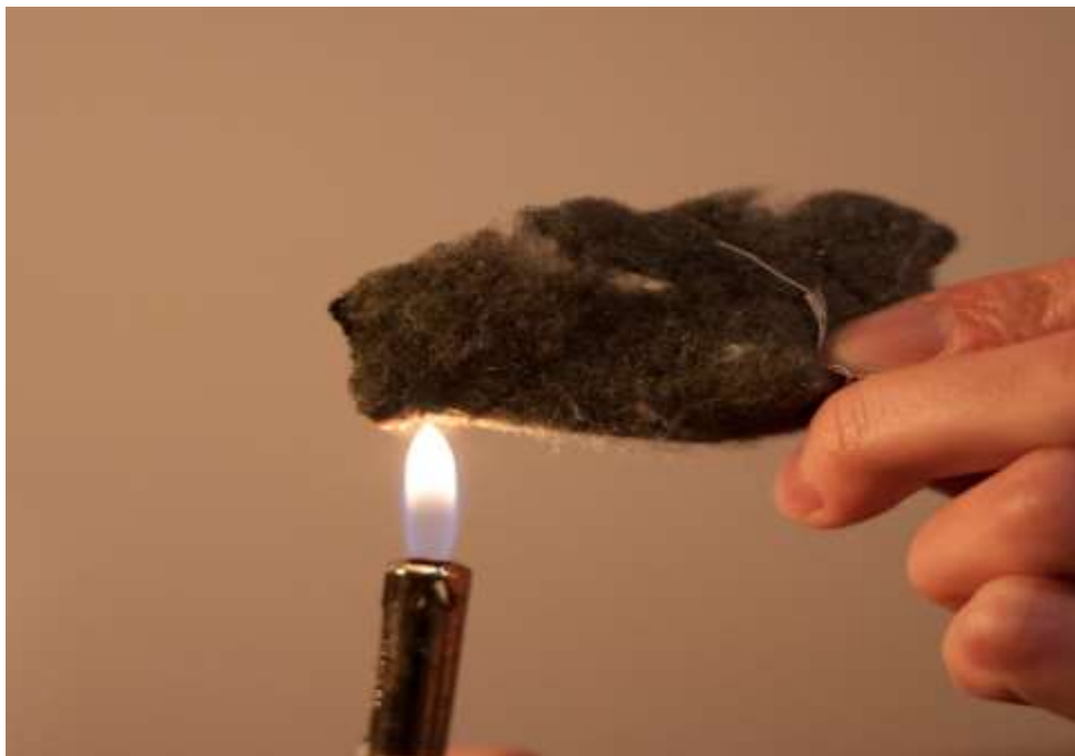
Slika 6.30. Toplinska podstava -runo u plamenu
