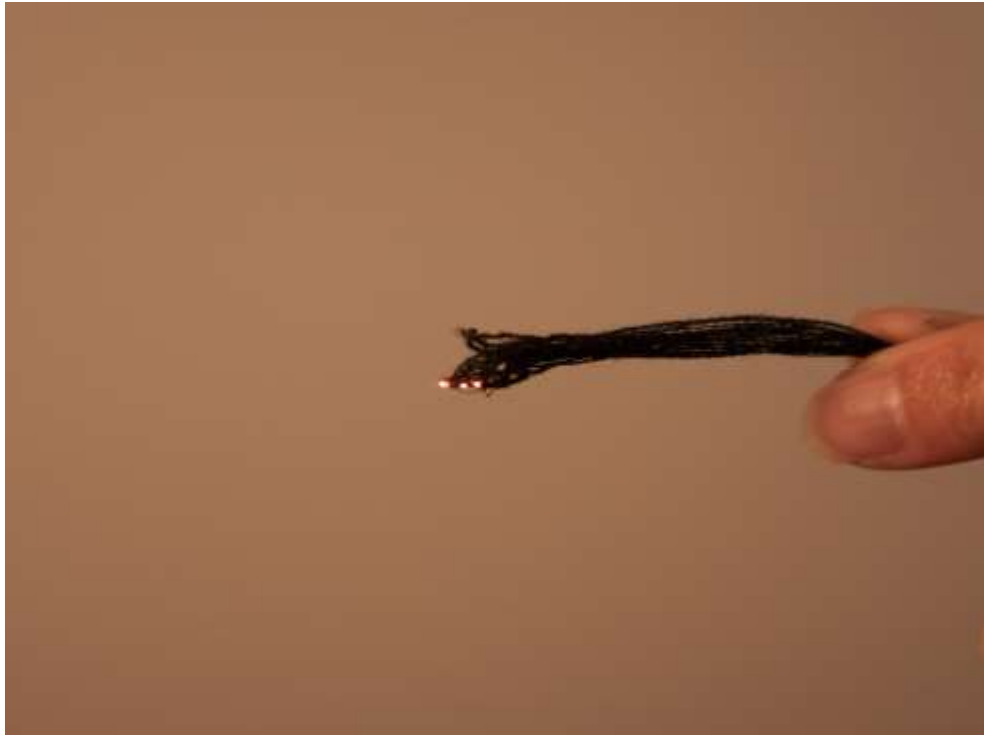
Slika 6.22. Fluorna vlakna nakon što se izvade iz plamena
