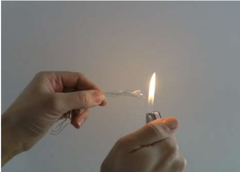
Slika 6.17. Akrilna vlakna prije ulaska u plamen
