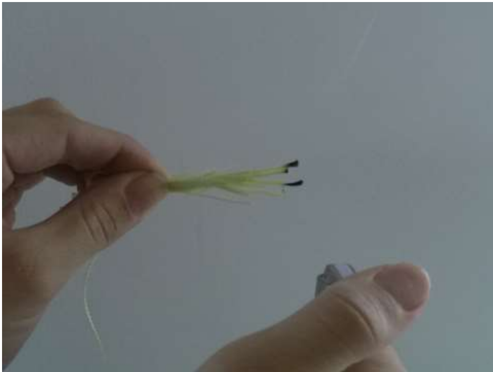
Slika 6.10. Aramidna vlakna nakon izlaska iz plamena
