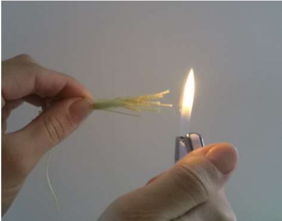
Slika 6.8. Aramidna vlakna prije ulaska u plamen
