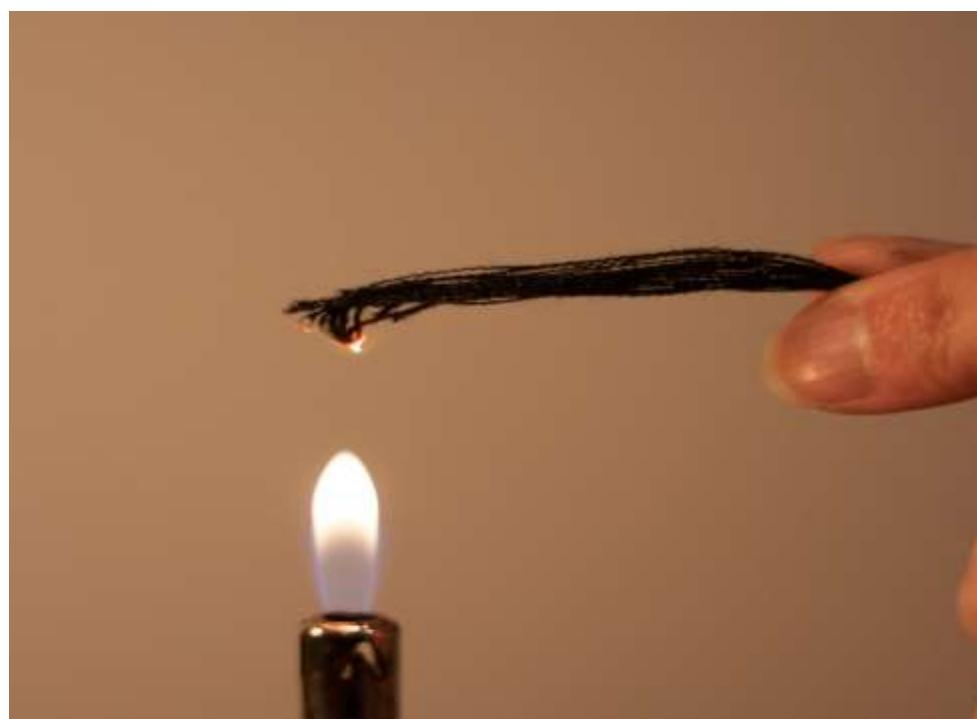
Slika 6.21. Fluorna vlakna u plamenu
