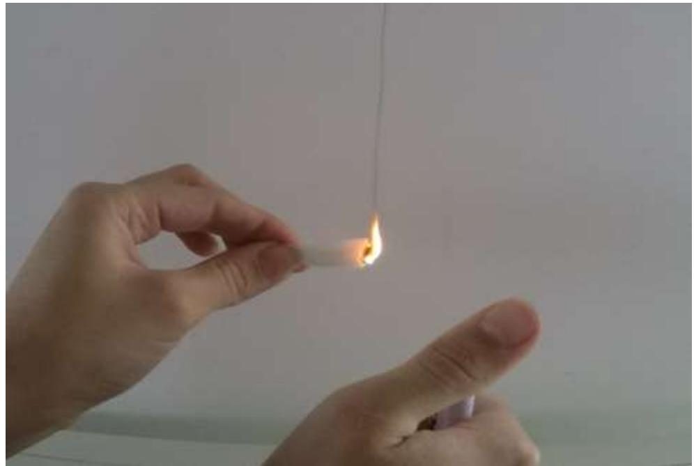
Slika 6.3. Poliesterska vlakna nakon odmicanja od plamena
