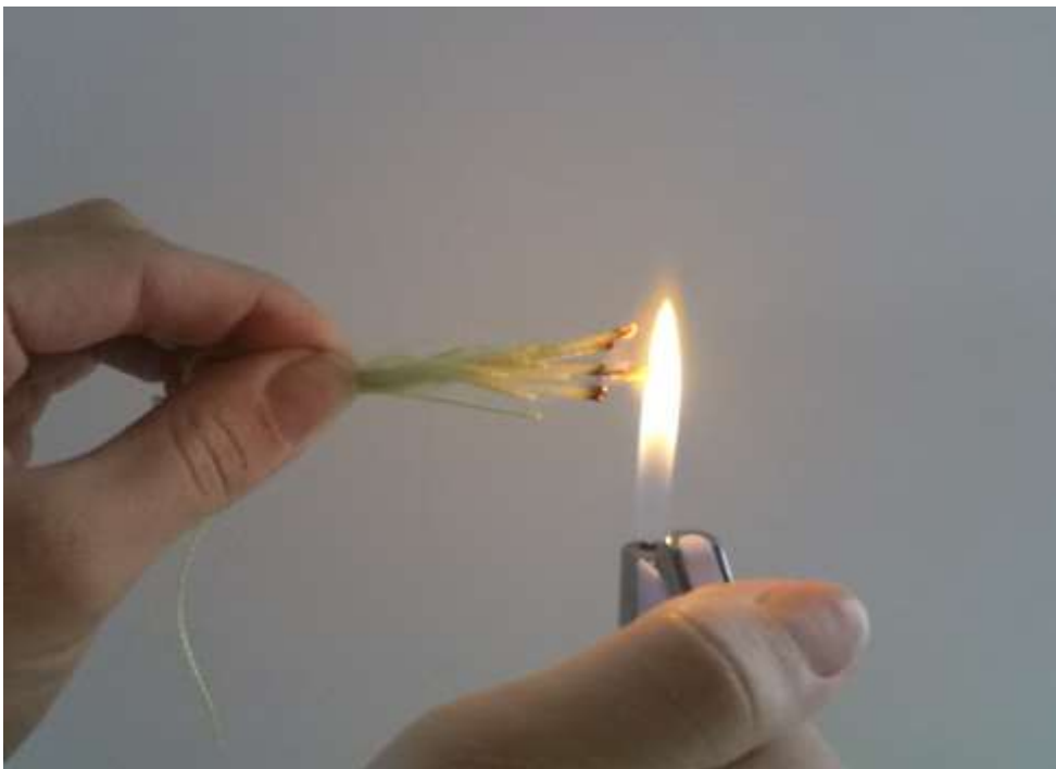
Slika 6.9. Aramidna vlakna prilikom ulaska u plamen
