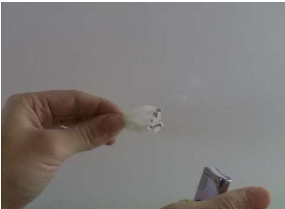
Slika 6.13. Polipropilenska vlakna nakon izlaska iz plamena
