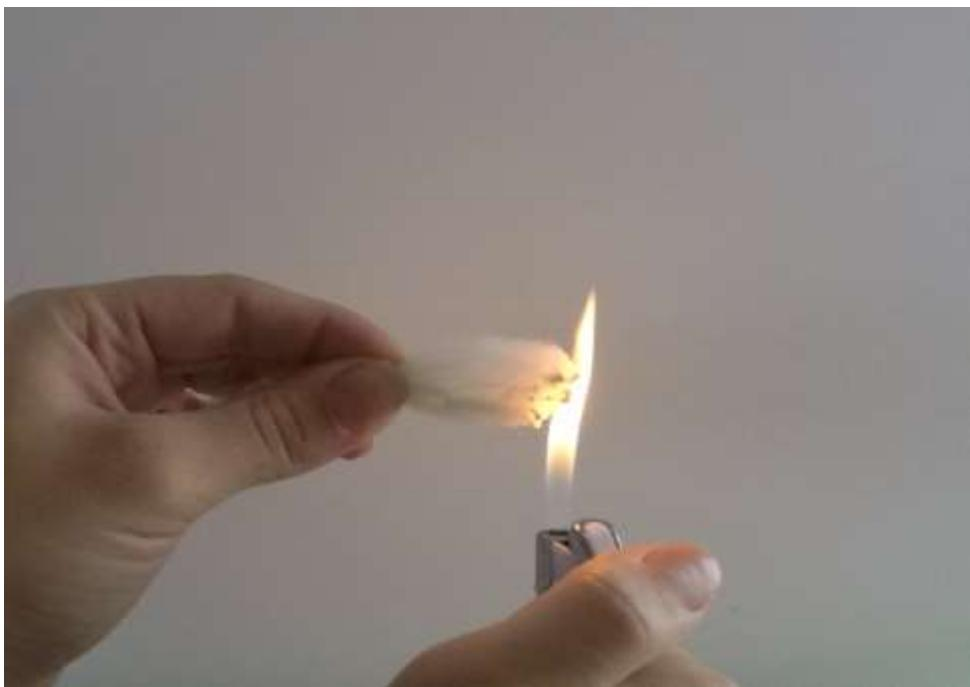
Slika 6.12. Polipropilenska vlakna u plamenu
