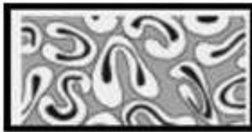
Slika 4.1. Uzdužna slika pamuka [25]
