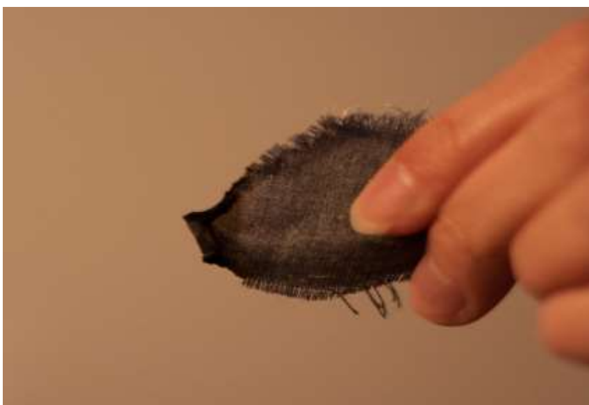
Slika 6.34. Tkanina nakon što se izvadi iz plamena
