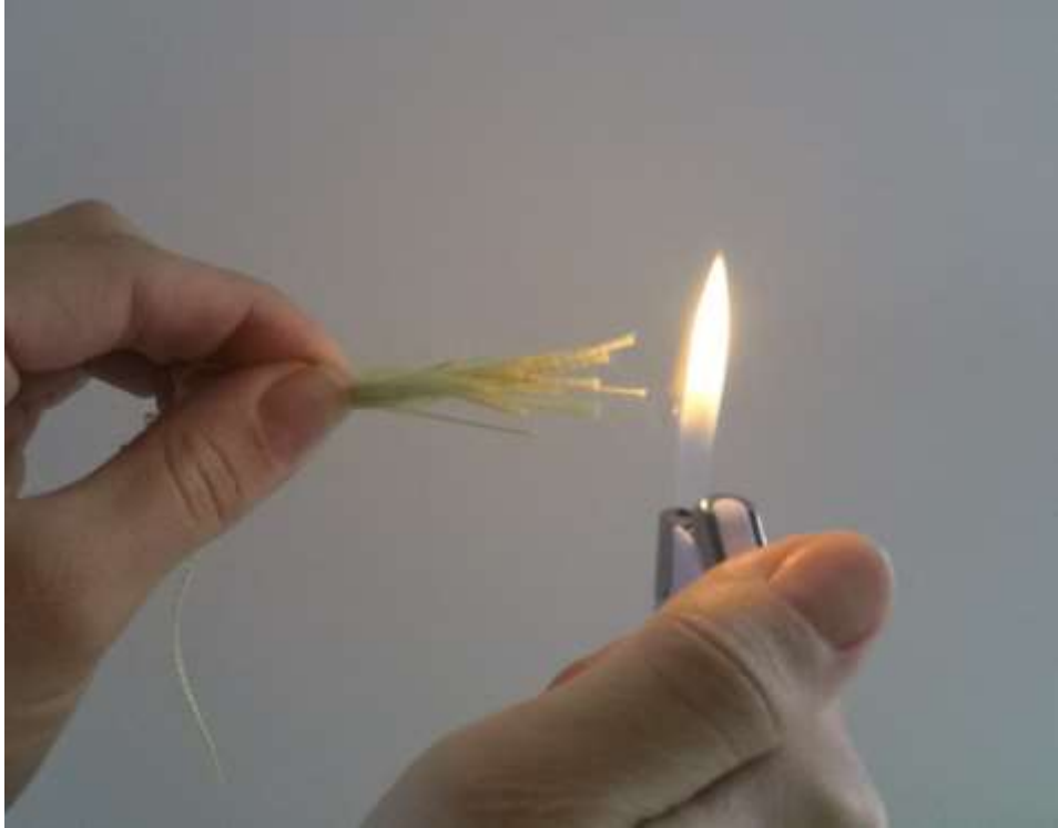
Slika 6.8. Aramidna vlakna prije ulaska u plamen
