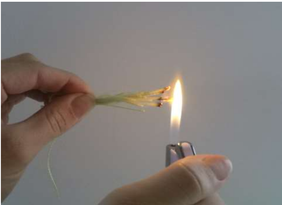
Slika 6.9. Aramidna vlakna prilikom ulaska u plamen
