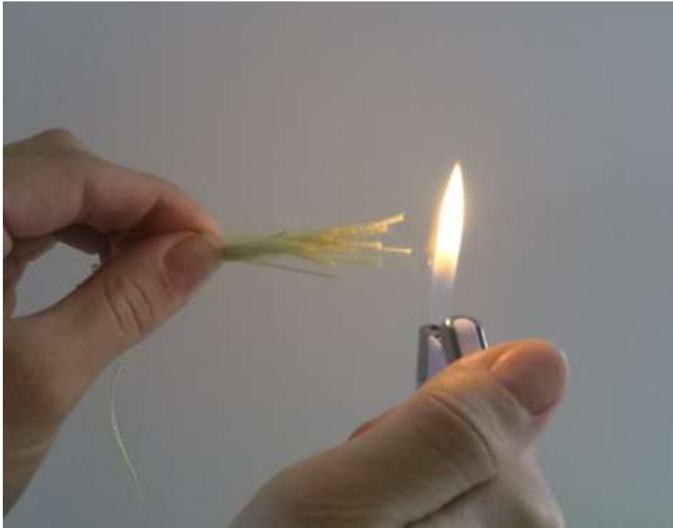
Slika 6.8. Aramidna vlakna prije ulaska u plamen
