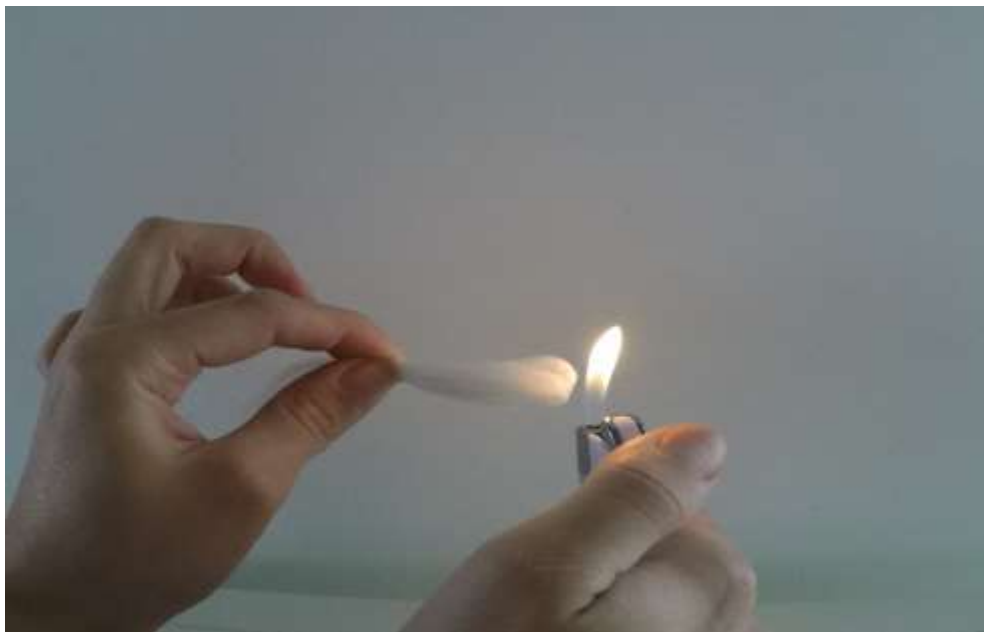
Slika 6.1. Poliesterska vlakna prije ulaska u plamen
