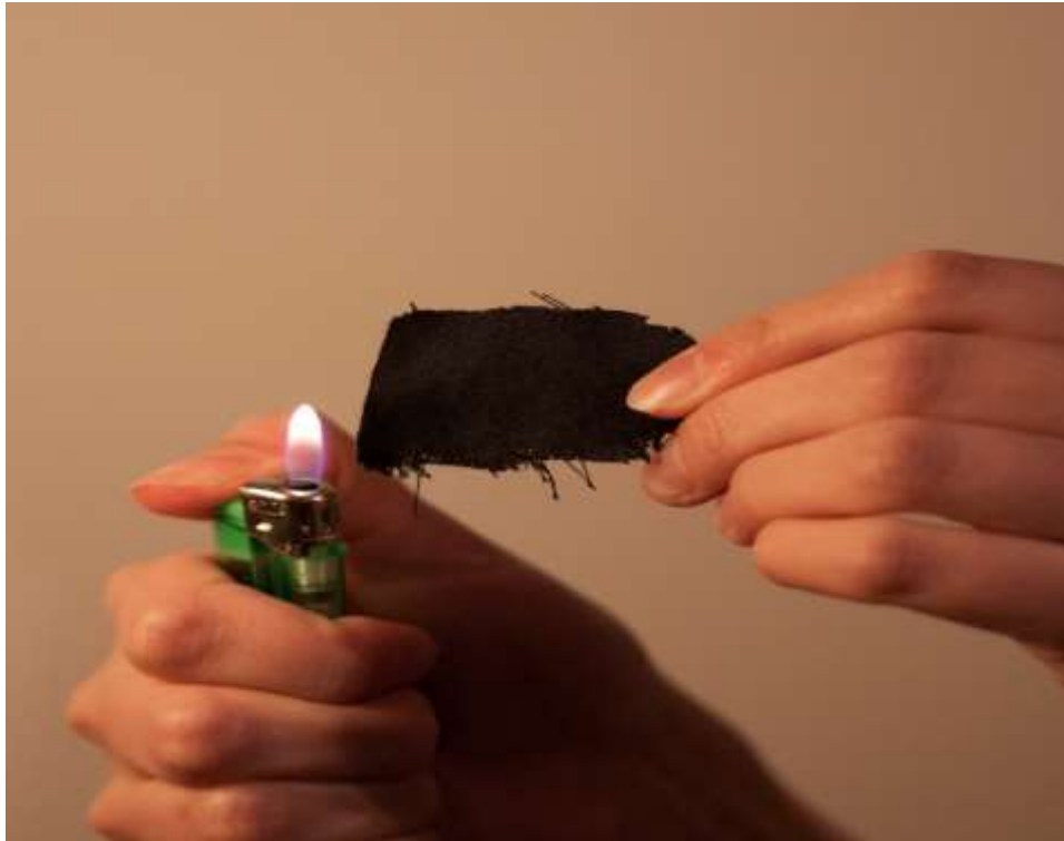
Slika 6.26. Vodoodbojni materijal prije ulaska u plamen
