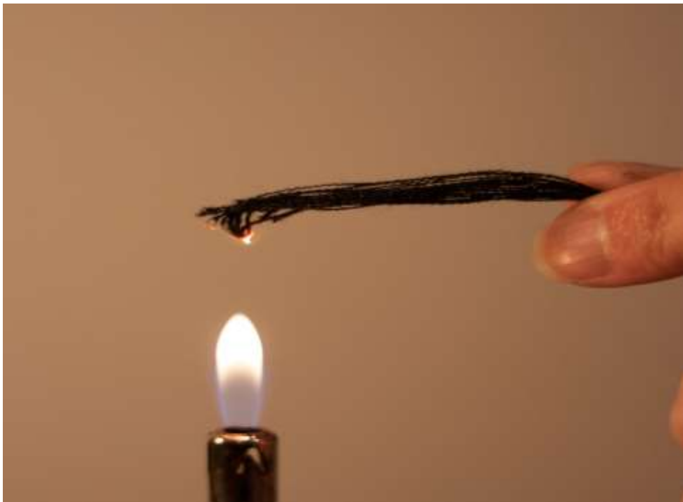
Slika 6.21. Fluorna vlakna u plamenu
