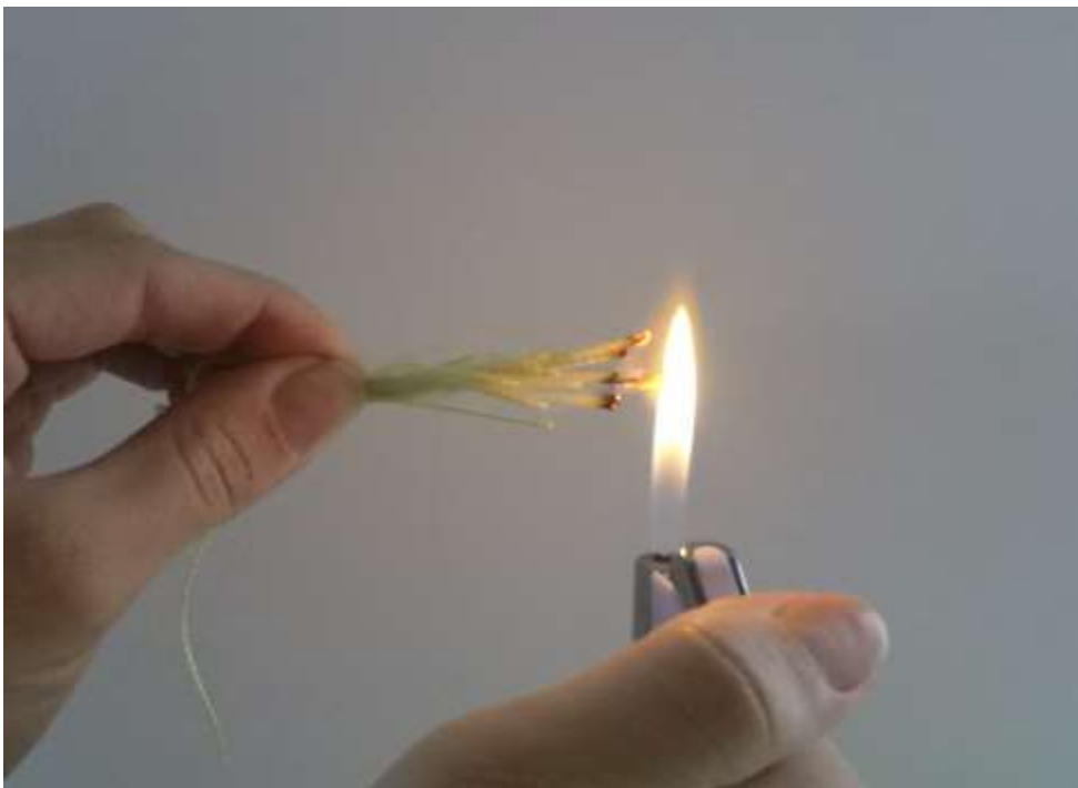
Slika 6.9. Aramidna vlakna prilikom ulaska u plamen
