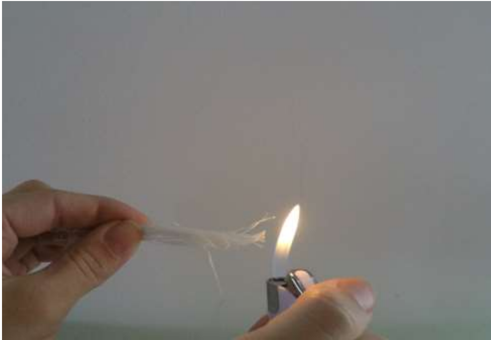
Slika 6.5. Poliamidna vlakna prije ulaska u plamen
