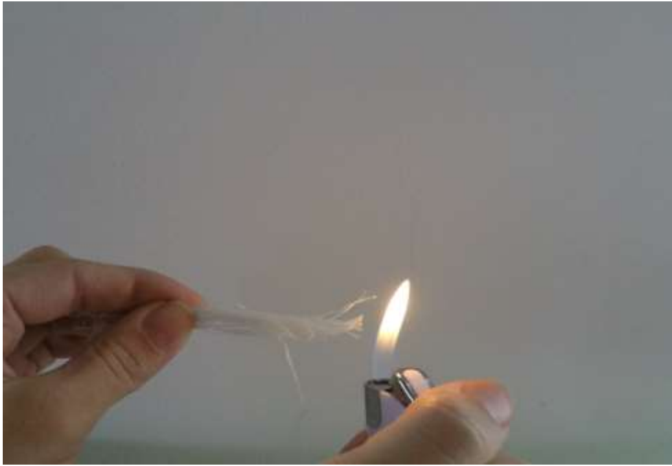
Slika 6.5. Poliamidna vlakna prije ulaska u plamen
