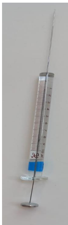
Slika 10. Mikrošprica za injektiranje uzorka dizel goriva
