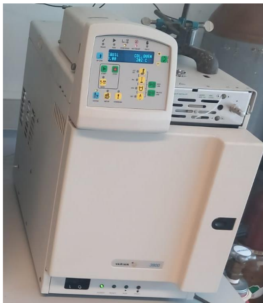
Slika 11. Prikaz kromatografa i injektiranja uzorka dizel goriva. Vlastita fotografija
