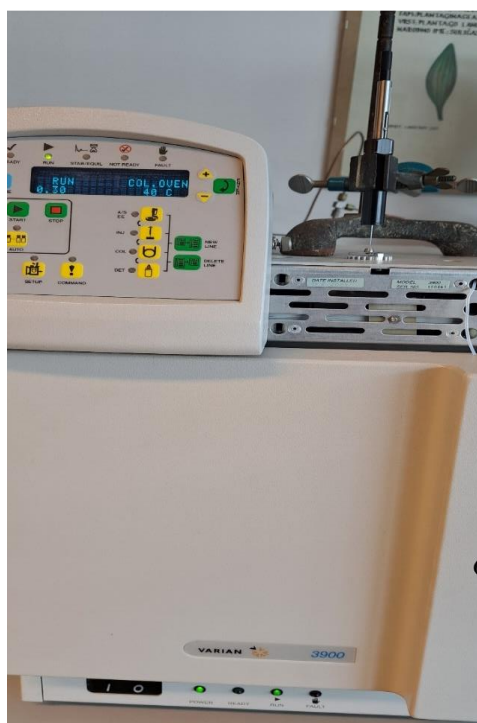
Slika 9. Prikaz injektiranja uzorka SPME iglom. Vlastita fotografija.
