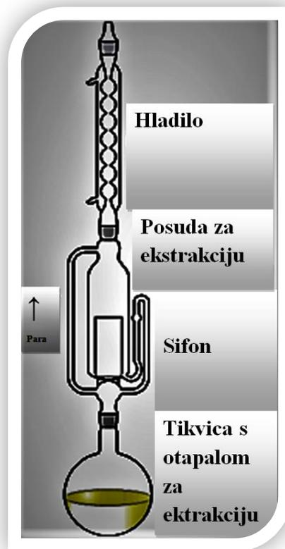
Slika 13. Soxhlet uređaj. Dostupno sa:
