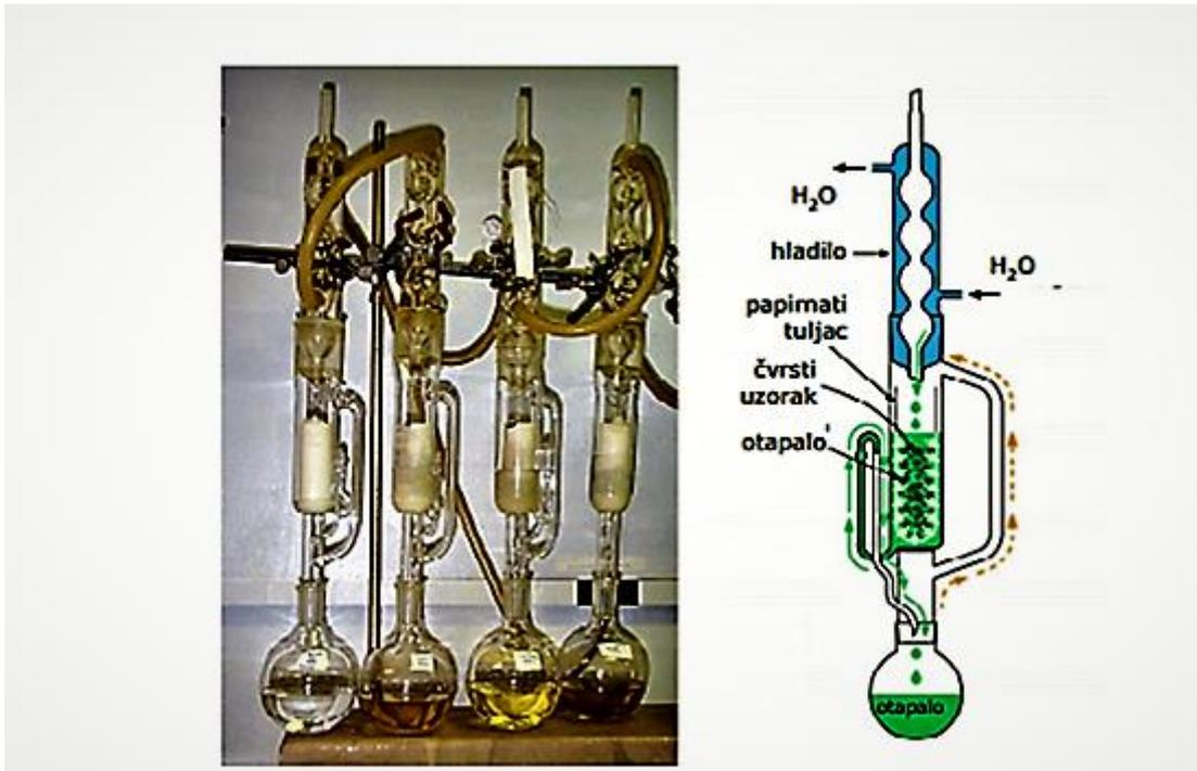
Slika 14. Povezani sustav Soxhlet uređaja. Dostupno sa:
