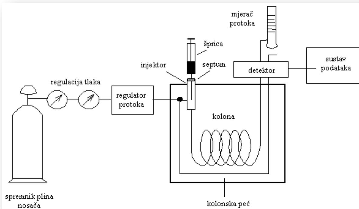
Slika 8. Osnovni dijelovi plinskog kromatografa. Dostupno na: [http://free-zg.t-com.hr/Svjetlana\\_Luterotti/09/091/0912.htm](http://free-zg.t-com.hr/Svjetlana_Luterotti/09/091/0912.htm); pristupljeno: 9.12.2018.
