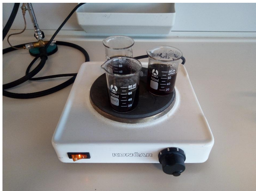
Slika 7. Uklanjanje ugljikovog dioksida iz uzoraka pića
