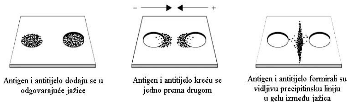
Slika 1. Prikaz precipitinskog testa
