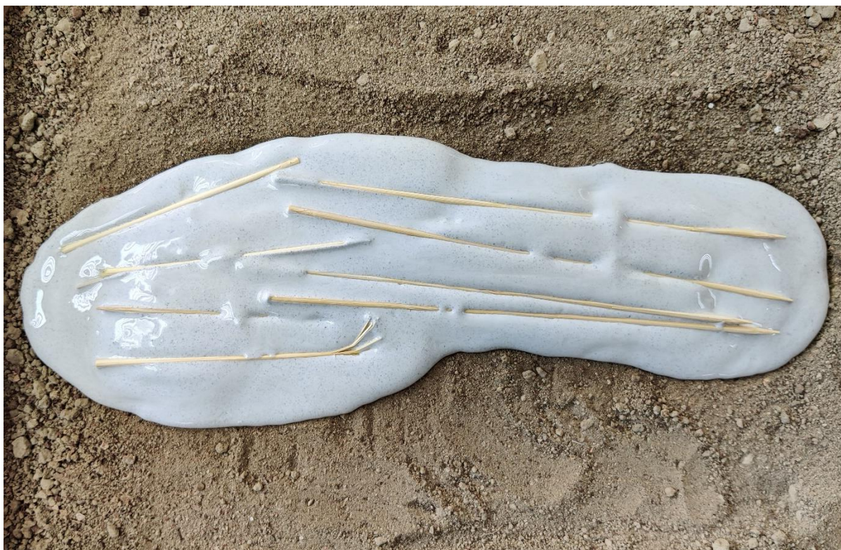
Slika 36. Korak 5. - Ojačavanje strukture odljevka stavljanjem drvenih štapića kao potpore (izvor: autor).
