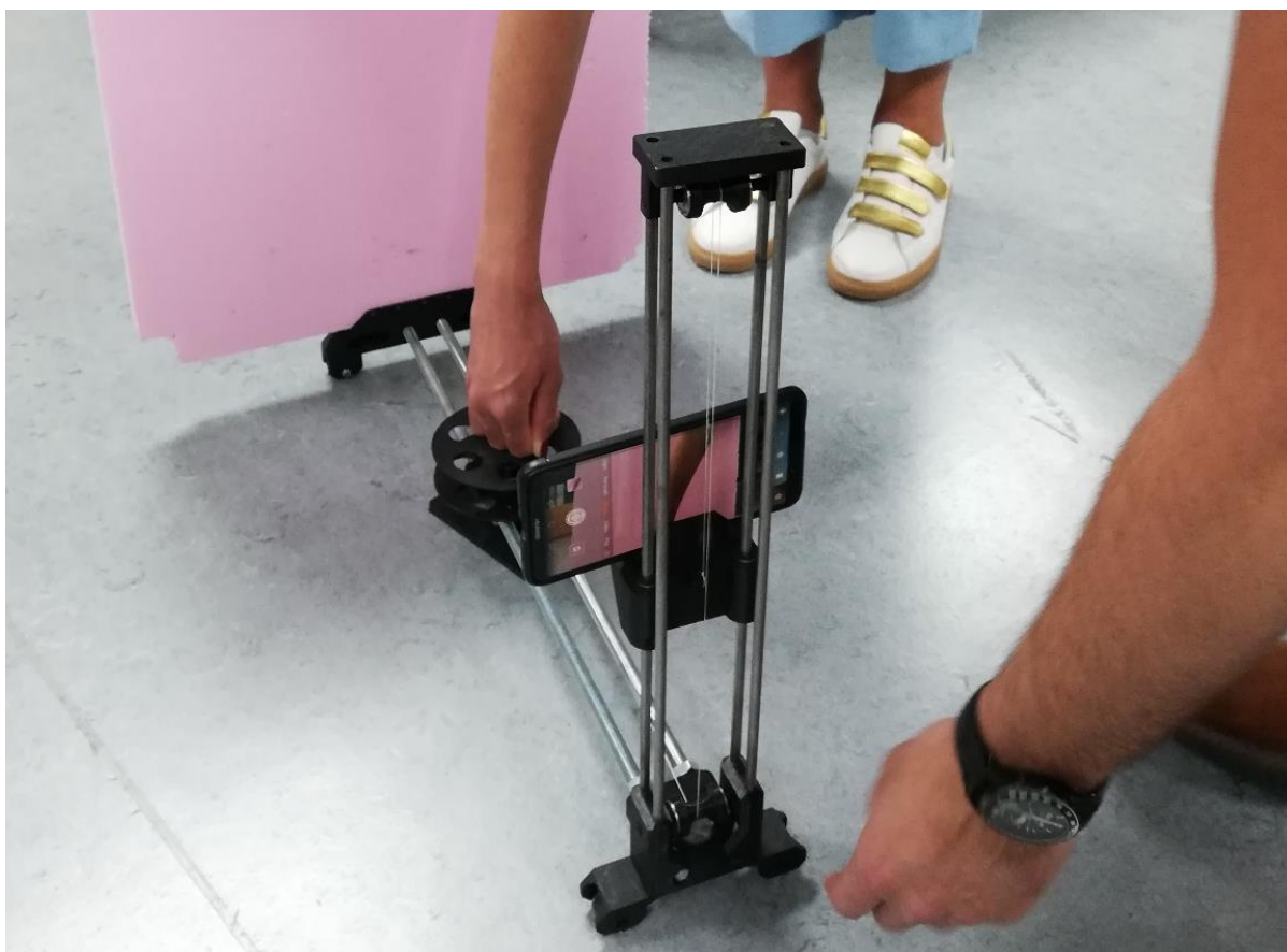
Slika 23. Snimanje fotografija postupkom fotogrametrije uporabom mobitela (izvor: autor).
