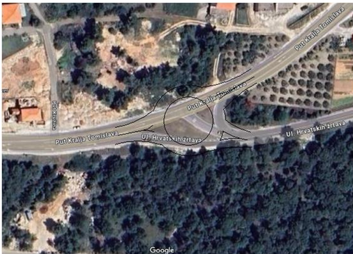
Slika 8 Prijedlog kružnog raskrižja Puta Kralja Tomislava i Ulice Hrvatskih žrtava u mjestu Seget Vranjica 8 Izvor: izradio autor
