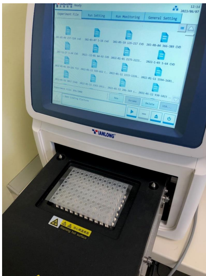
Slika 16. PCR pločica unutar PCR uređaja Gentier 96E (izvor: NZJZ)
