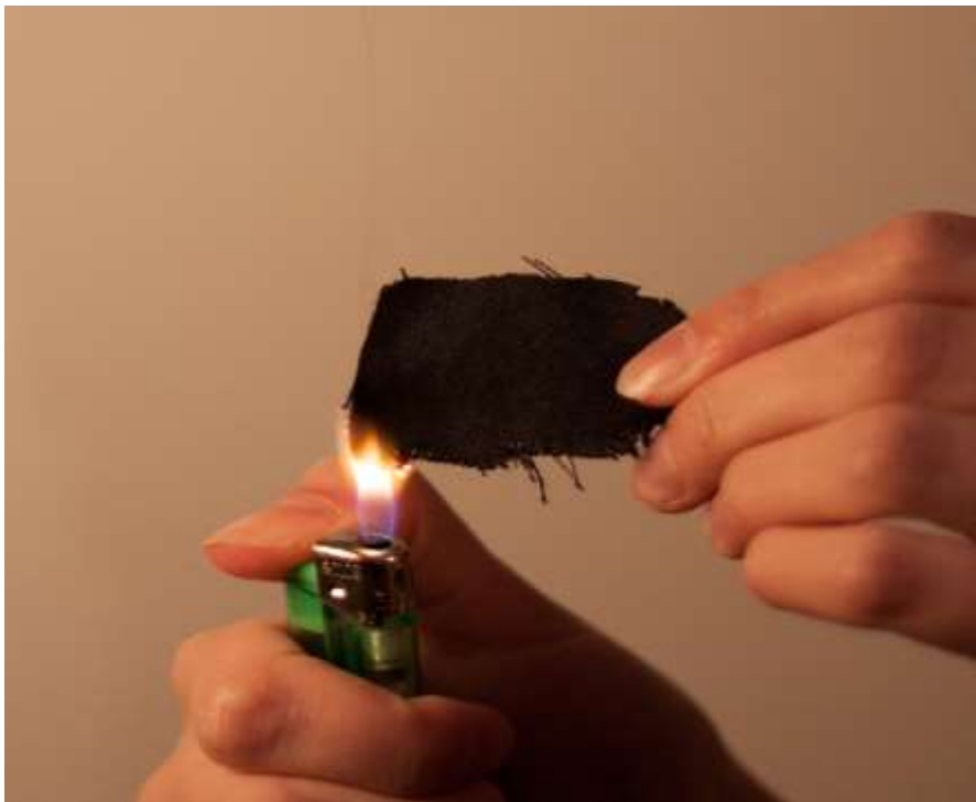
Slika 6.27. Vodoodbojni materijal u plamenu
