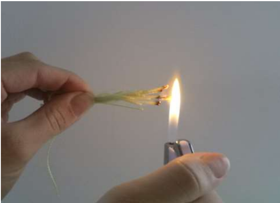
Slika 6.9. Aramidna vlakna prilikom ulaska u plamen
