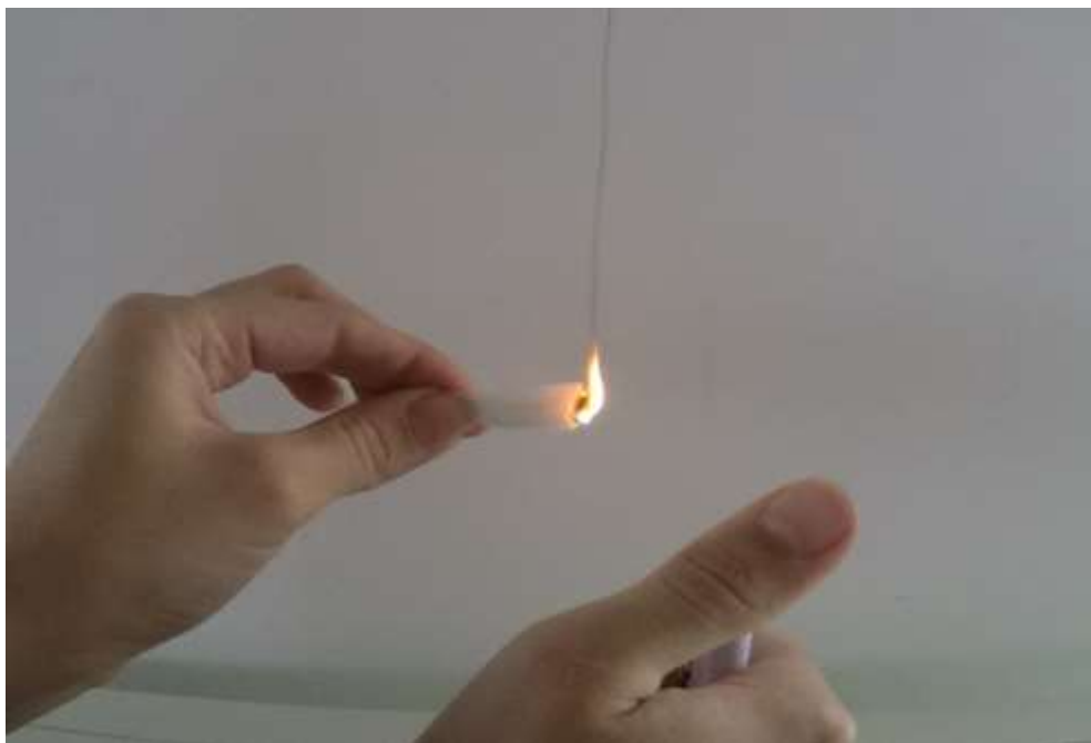
Slika 6.3. Poliesterska vlakna nakon odmicanja od plamena
