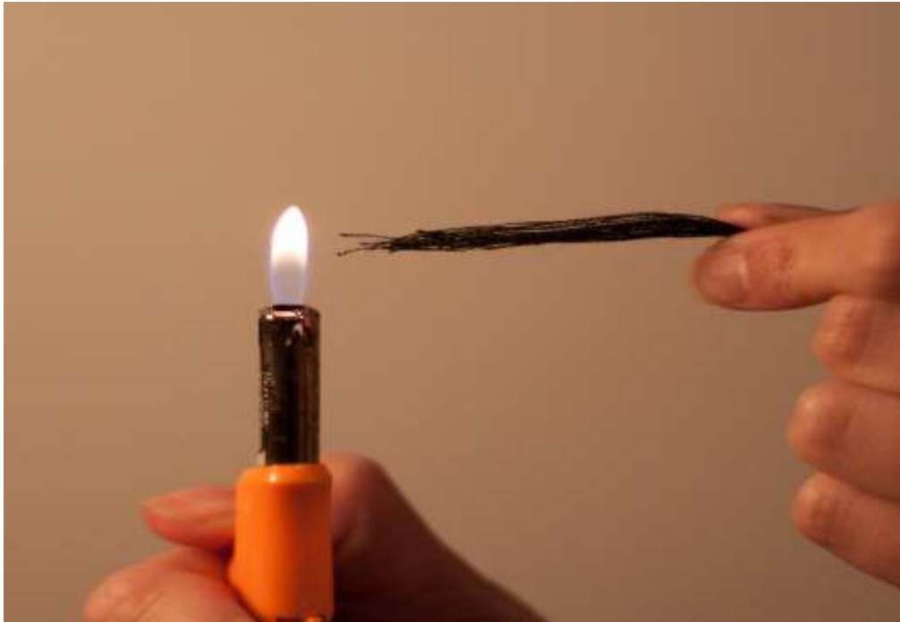
Slika 6.20. Fluorna vlakna u blizini plamena
