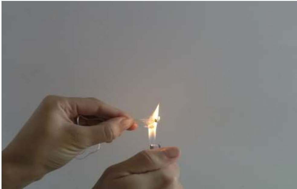
Slika 6.18. Akrilna vlakna u plamenu
