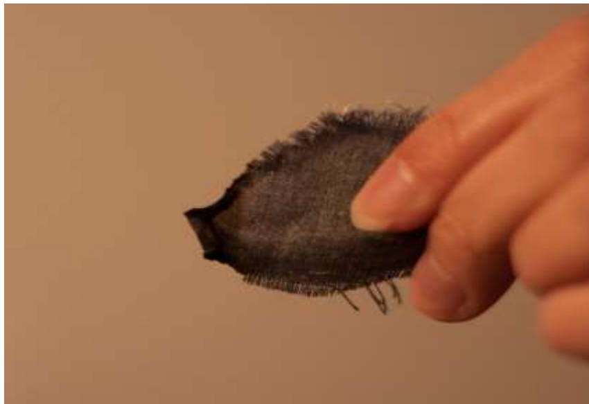
Slika 6.34. Tkanina nakon što se izvadi iz plamena
