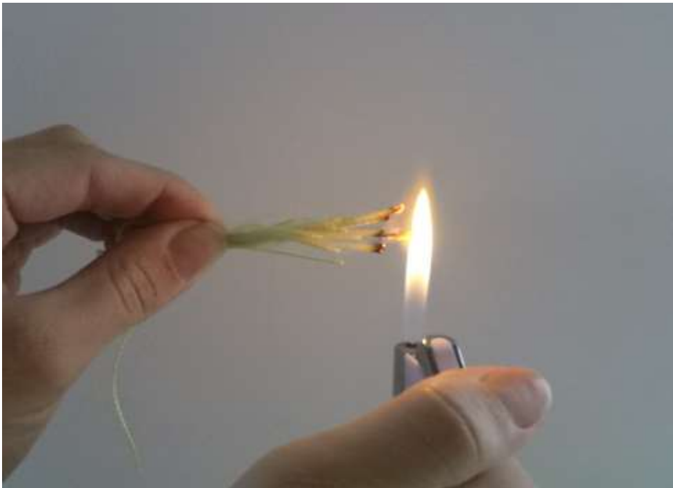
Slika 6.9. Aramidna vlakna prilikom ulaska u plamen
