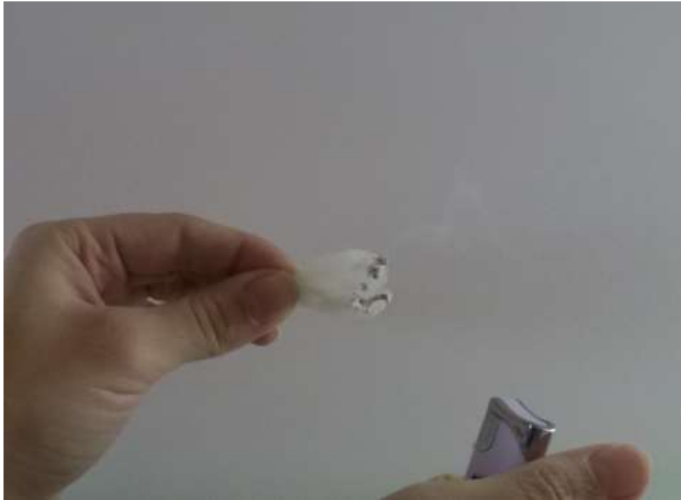
Slika 6.13. Polipropilenska vlakna nakon izlaska iz plamena
