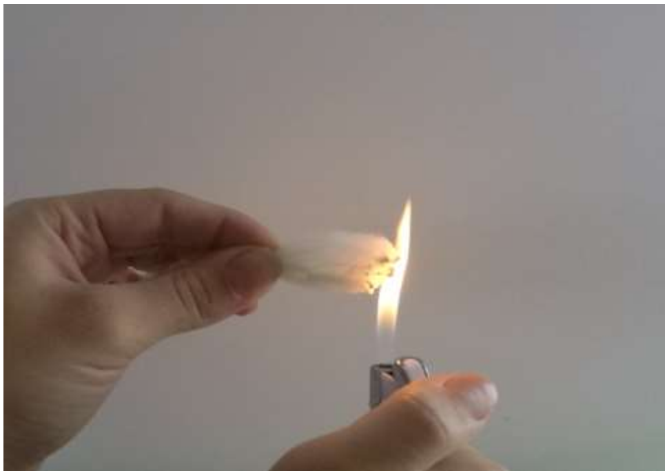
Slika 6.12. Polipropilenska vlakna u plamenu
