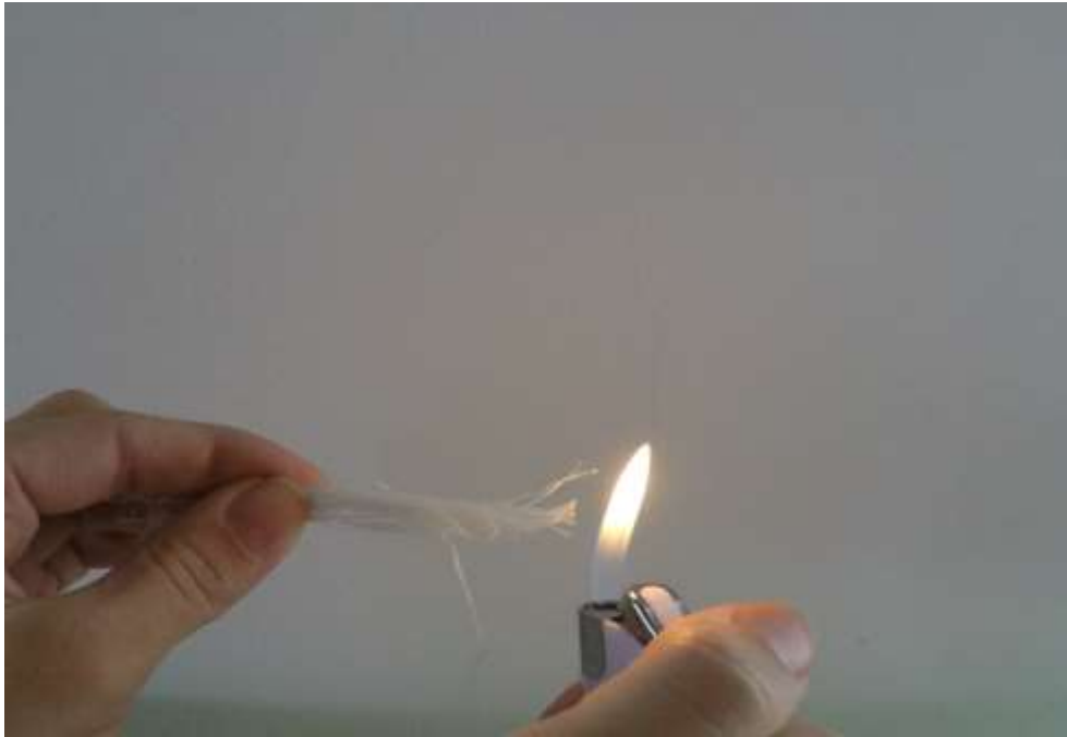
Slika 6.5. Poliamidna vlakna prije ulaska u plamen
