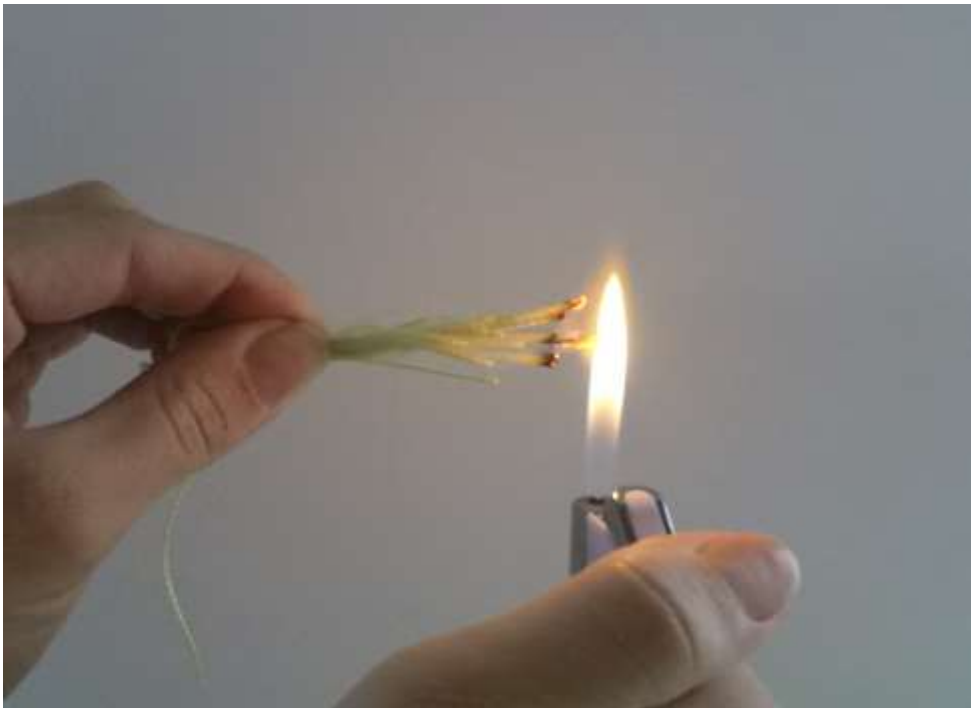
Slika 6.9. Aramidna vlakna prilikom ulaska u plamen
