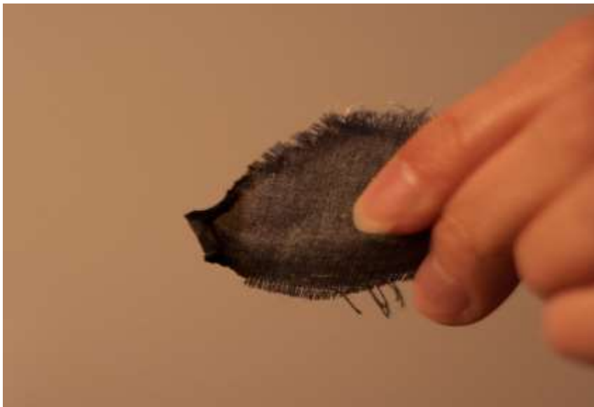
Slika 6.34. Tkanina nakon što se izvadi iz plamena
