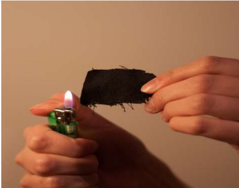
Slika 6.26. Vodoodbojni materijal prije ulaska u plamen
