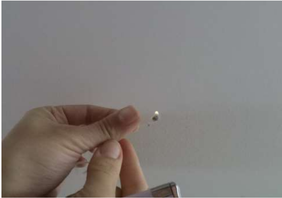
Slika 6.16. Polietilenska vlakna nakon palmena
