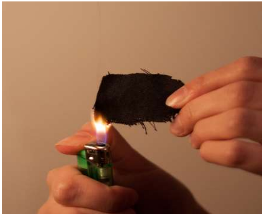
Slika 6.27. Vodoodbojni materijal u plamenu
