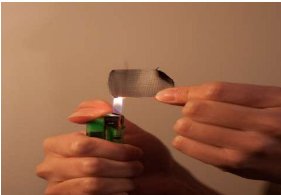
Slika 6.24. Vanjski sloj u plamenu
