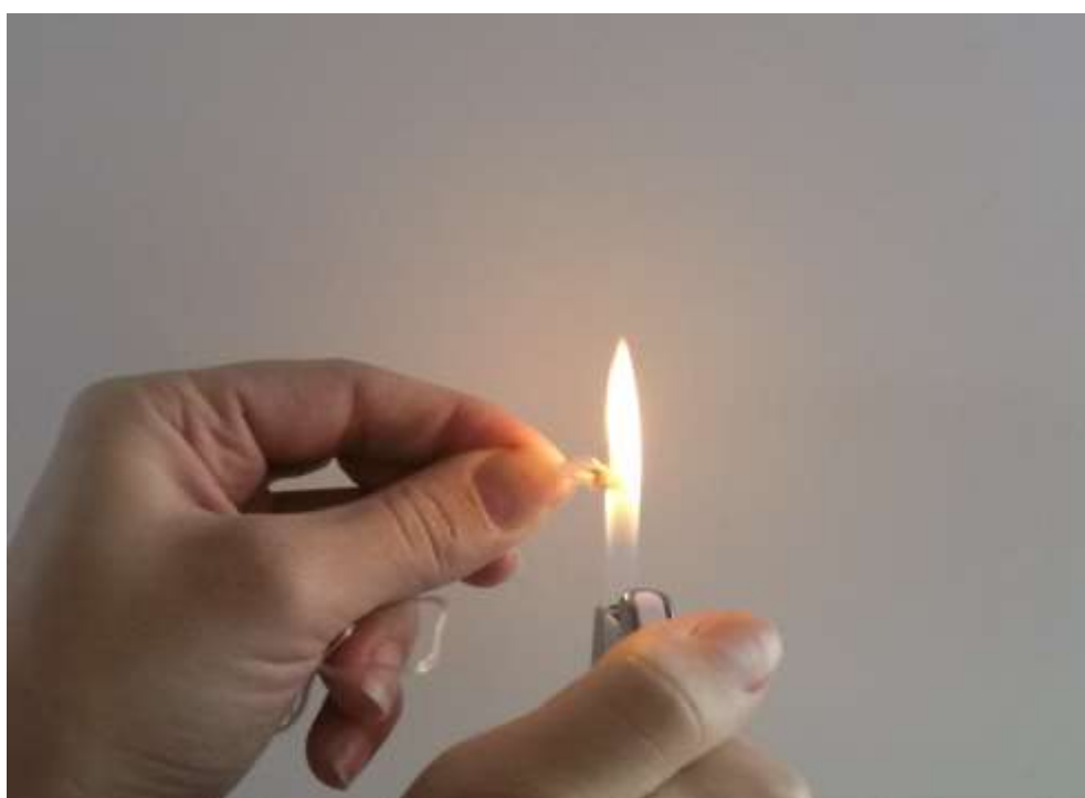
Slika 6.15. Polietilenska vlakna u plamenu
