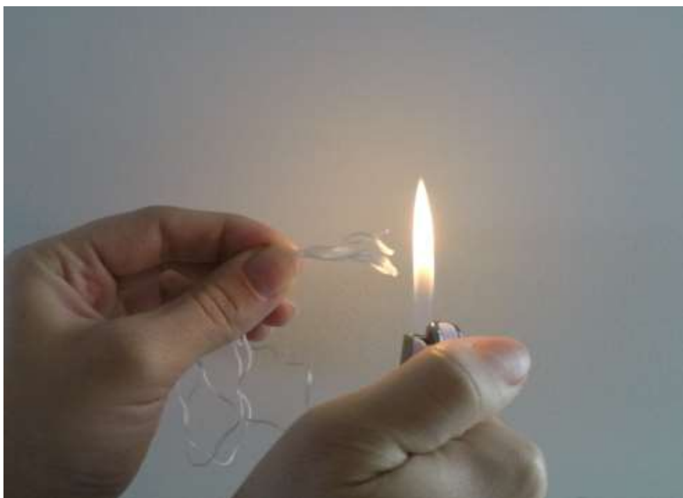
Slika 6.14. Polietilenska vlakna prije ulaska u plamen
