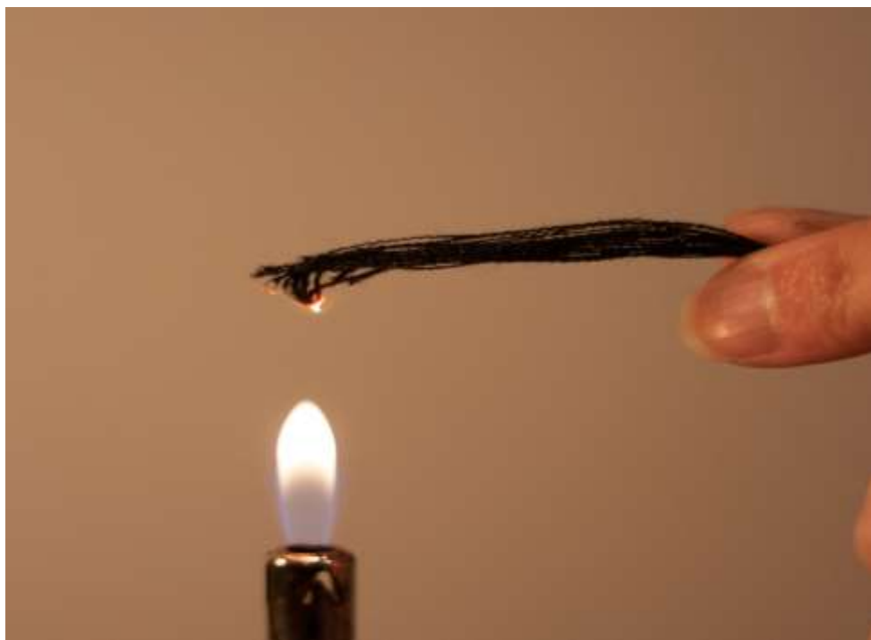
Slika 6.21. Fluorna vlakna u plamenu
