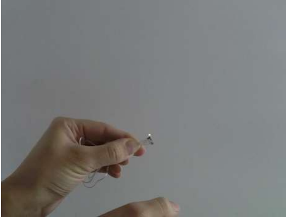
Slika 6.19. Akrilna vlakna nakon izlaska iz plamena
