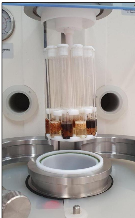
Slika 8. Uzorci prije i nakon mikrovalne razgradnje (izvor: autor)
