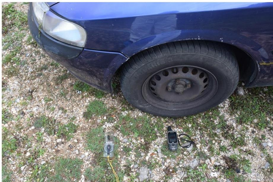
Slika 4. Određivanje FTM i PTM, GPS uređajem
