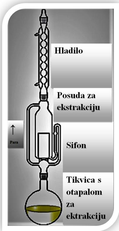
Slika 13. Soxhlet uređaj. Dostupno sa:
