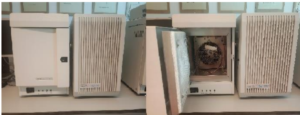
Slika 7. Uređaj za plinsku kromatografiju i masenu spektrometriju GC-MS, Izvor: Autor
