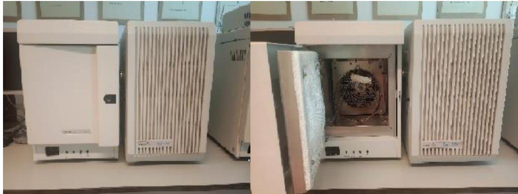
Slika 7. Uređaj za plinsku kromatografiju i masenu spektrometriju GC-MS, Izvor: Autor
