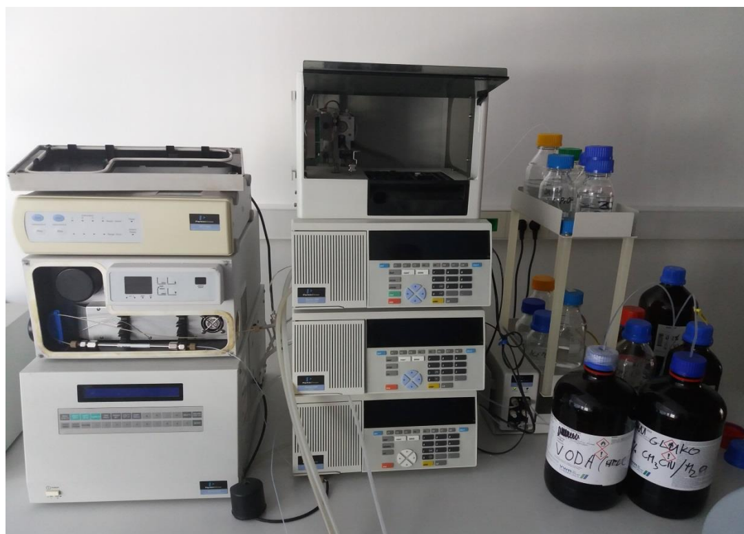
Slika 11. HPLC uređaj korišten za analizu uzoraka
