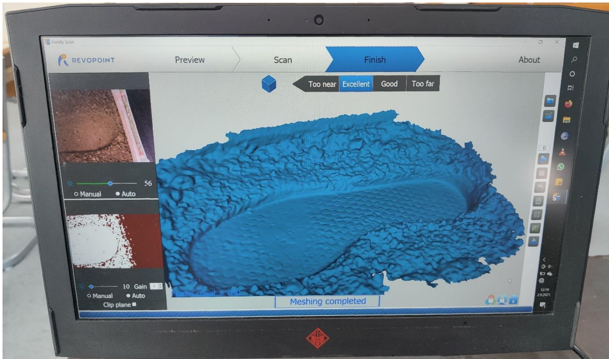
Slika 67. Korak 3. – Izrada žičanog ili mrežnog modela iz oblaka točaka (izvor: autor).
