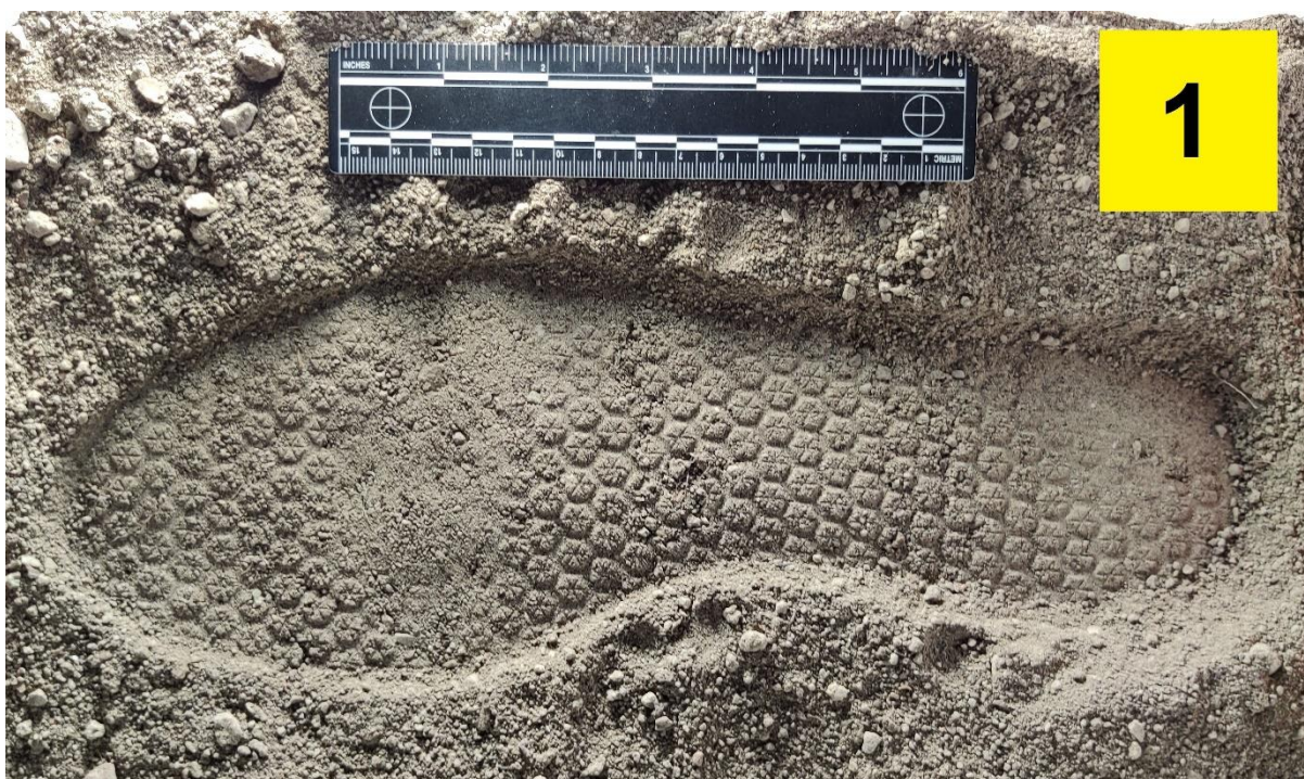
Slika 31. Korak 1. - Fotografiranje traga uz pripadajuću brojčanu oznaku i mjernu traku (izvor: autor).
