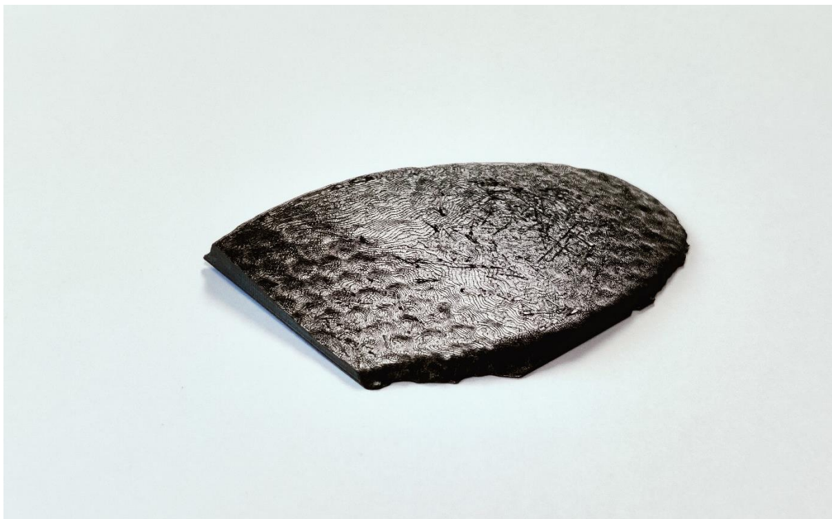
Slika 85. 3D model prednjeg dijela potplata ispisan na 3D printeru, pogled 1 (izvor: autor).
