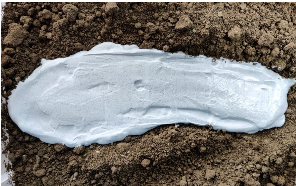
Slika 27. Korak 4. - Prekrivanje odljevka drugim slojem gipsane mase (izvor: autor).
