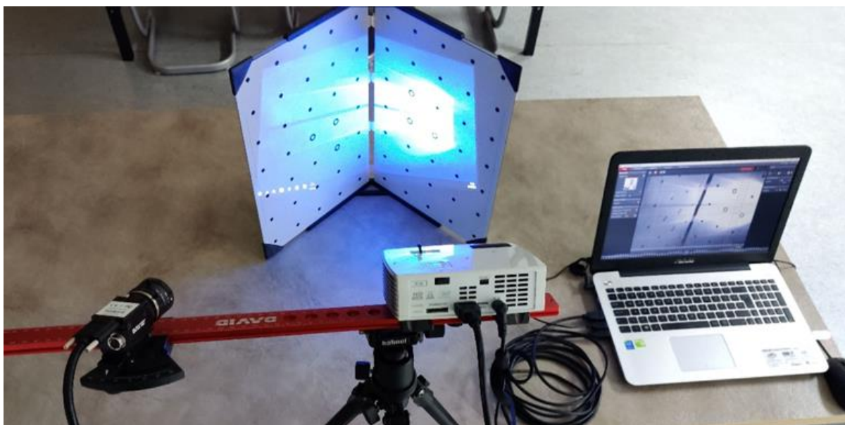
Slika 20. DAVID SLS 3D skener – White light skener (izvor: autor).
