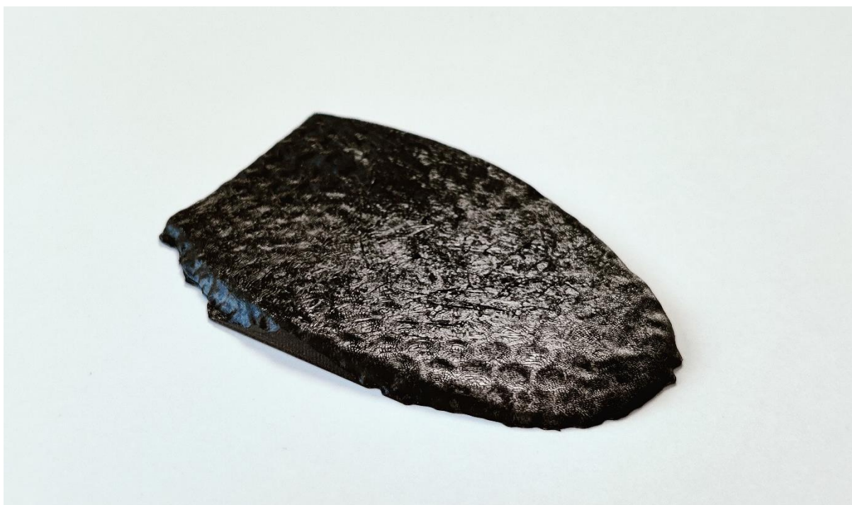
Slika 86. 3D model prednjeg dijela potplata ispisan na 3D printeru, pogled 2 (izvor: autor).
