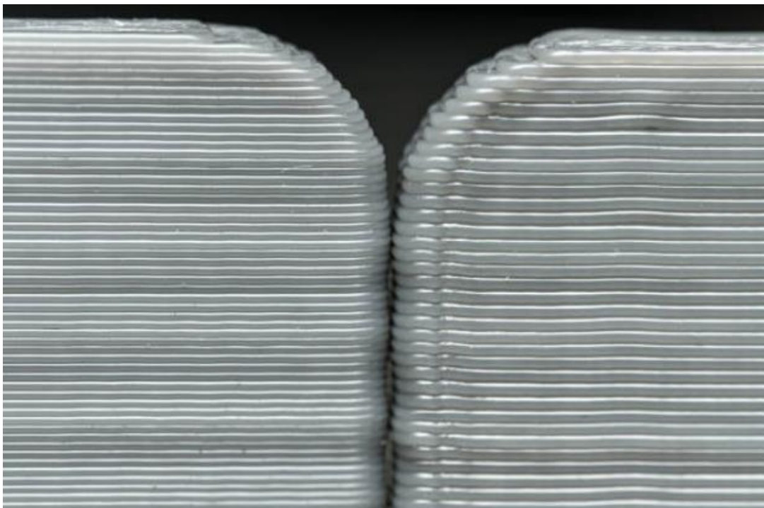
Slika 18. Razlika u visini slojeva pri ispisu s manjim i većim promjerom mlaznice (25).
