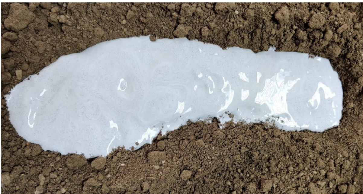
Slika 25. Korak 2. - Prekrivanje utiska prvim slojem gipsane mase rjeđe konzistencije (izvor: autor).
