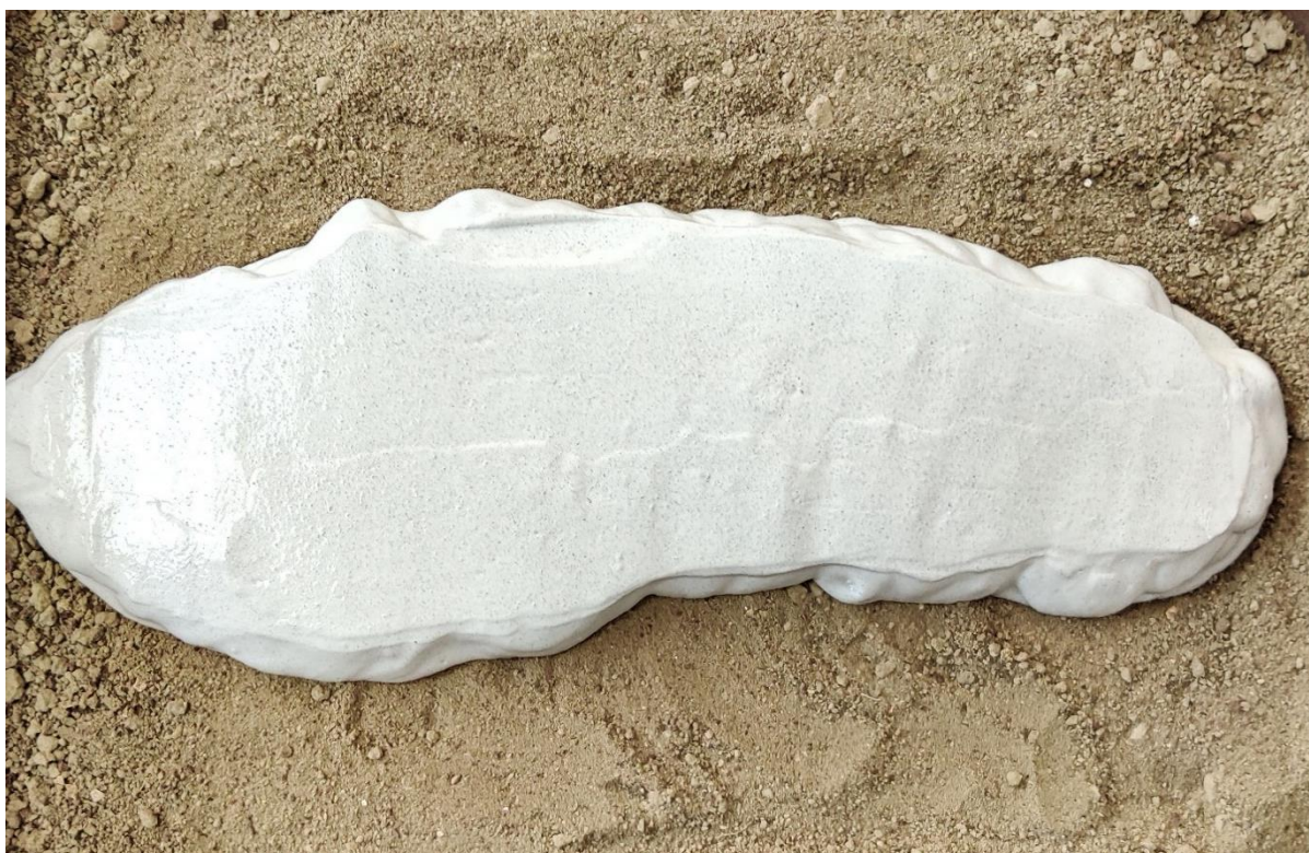
Slika 37. Korak 6. - Prekrivanje drugim slojem gipsane mase (izvor: autor).
