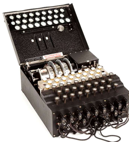
Slika 9. Enigma – varijanta s tri rotora (12)
