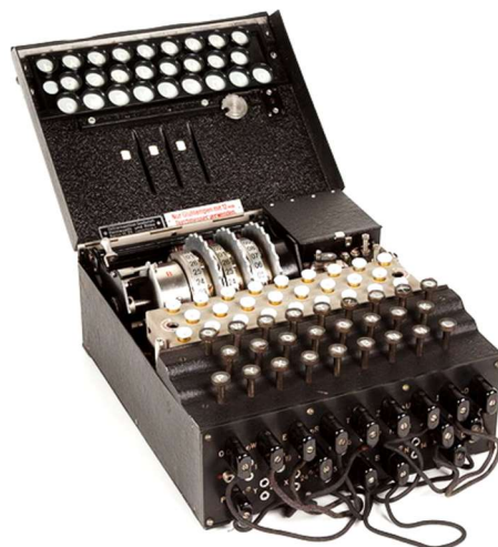
Slika 9. Enigma – varijanta s tri rotora (12)
