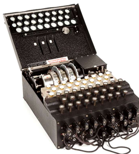
Slika 9. Enigma – varijanta s tri rotora (12)
