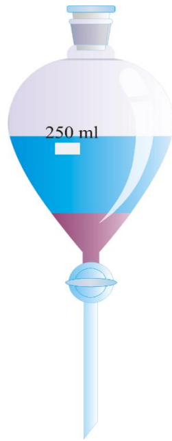
Slika 10. Lijevak za odjeljivanje (23)
