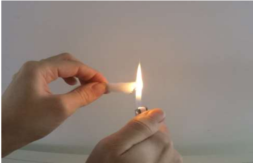
Slika 6.2. Poliesterska vlakna u plamenu
