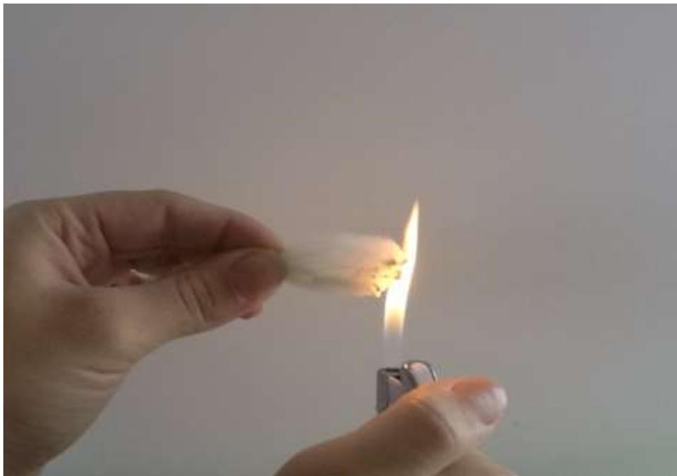
Slika 6.12. Polipropilenska vlakna u plamenu
