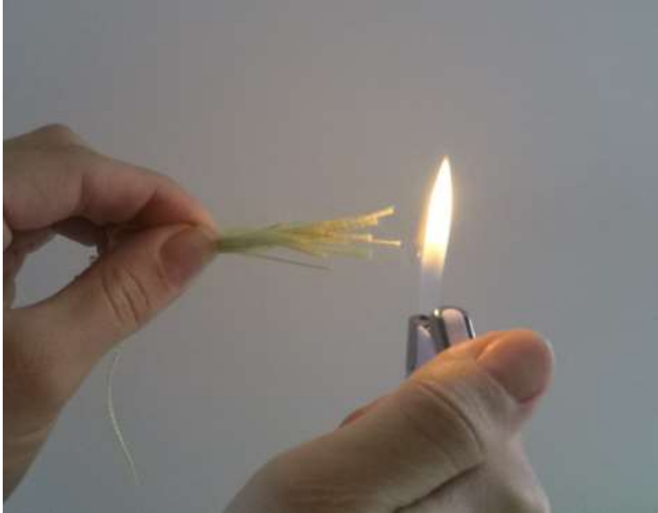
Slika 6.8. Aramidna vlakna prije ulaska u plamen
