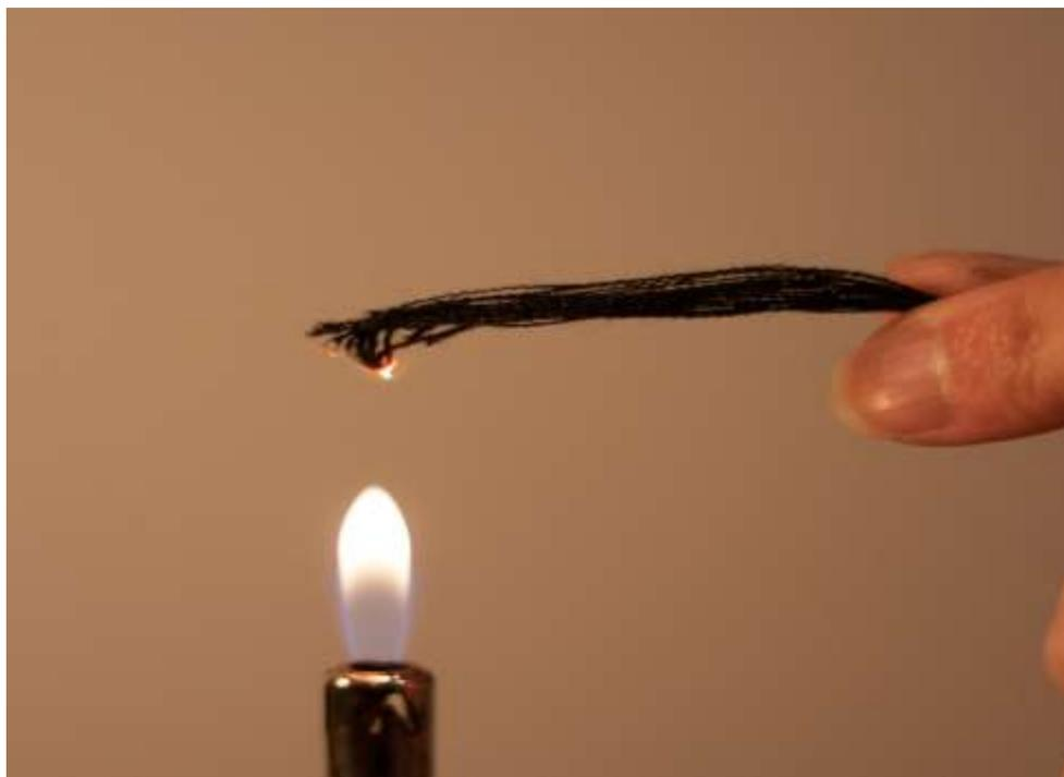
Slika 6.21. Fluorna vlakna u plamenu
