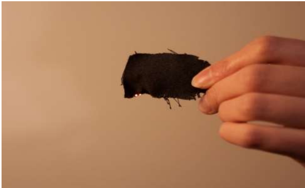
Slika 6.28. Vodoodbojni materijal nakon što ga se izvadi iz plamena
