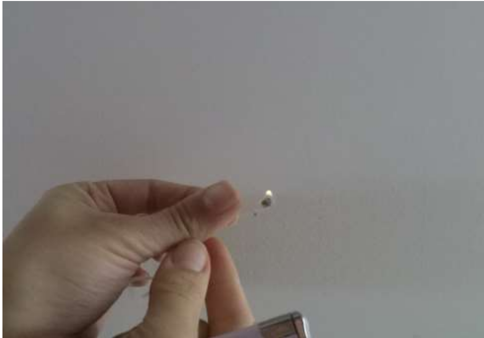
Slika 6.16. Polietilenska vlakna nakon palmena
