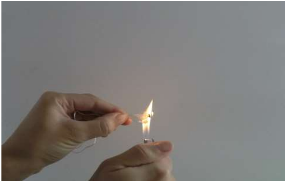
Slika 6.18. Akrilna vlakna u plamenu
