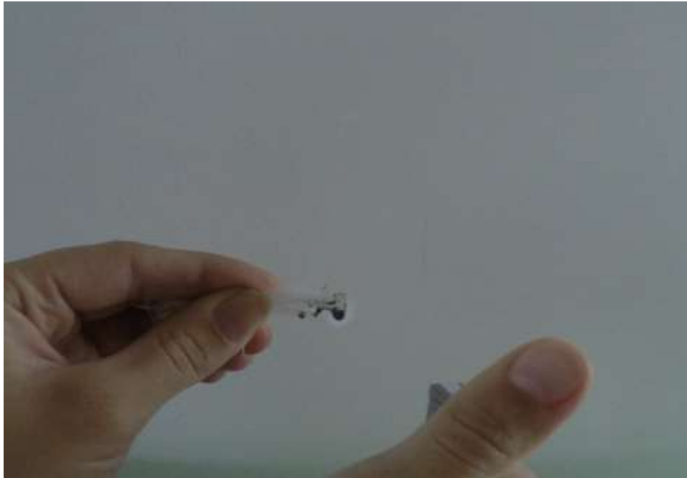
Slika 6.7. Poliamidna vlakna nakon što ih se izvadi iz plamena
