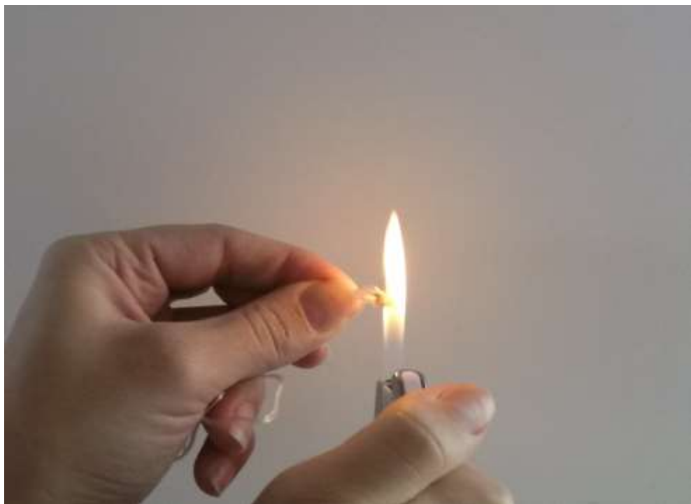
Slika 6.15. Polietilenska vlakna u plamenu
