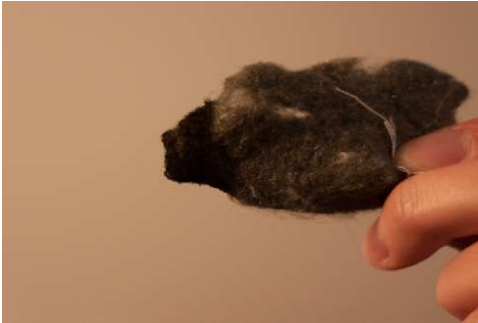
Slika 6.31. Toplinska podstava -runo nakon što ga se izvadi iz plamena
