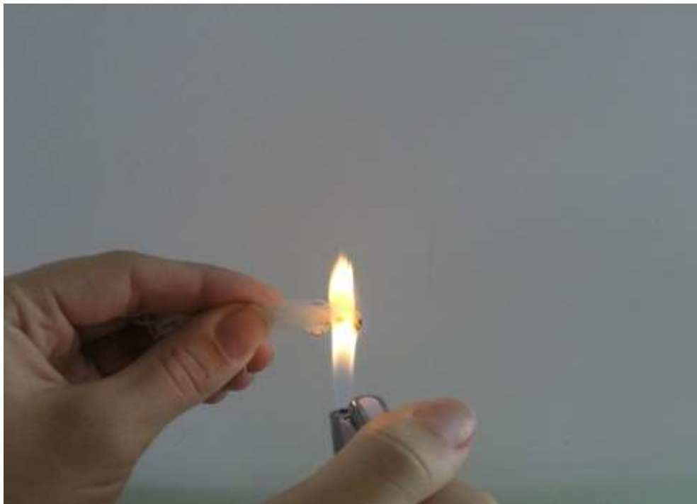
Slika 6.6. Poliamidna vlakna u plamenu
