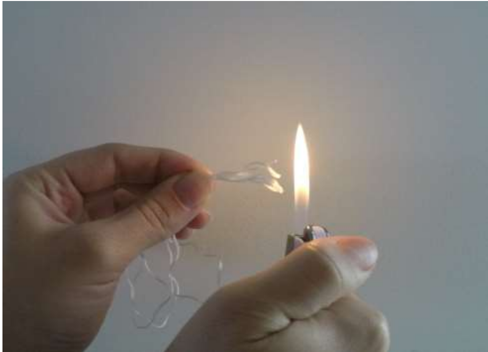
Slika 6.14. Polietilenska vlakna prije ulaska u plamen
