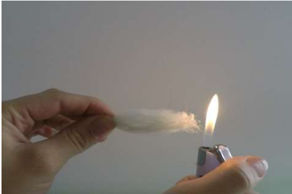
Slika 6.11. Polipropilensko vlakno prije ulaska u plamen
