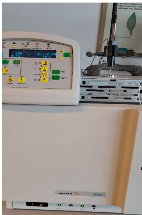
Slika 9. Prikaz injektiranja uzorka SPME iglom. Vlastita fotografija.
