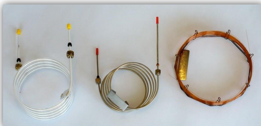
Slika 10. Staklena, punjena i kapilarna kolona. Dostupno na: http://people.whitman.edu/~dunnivfm/C_MS_Ebook/CH2/2_3_3.html ; pristupljeno: 7.11.2018.
