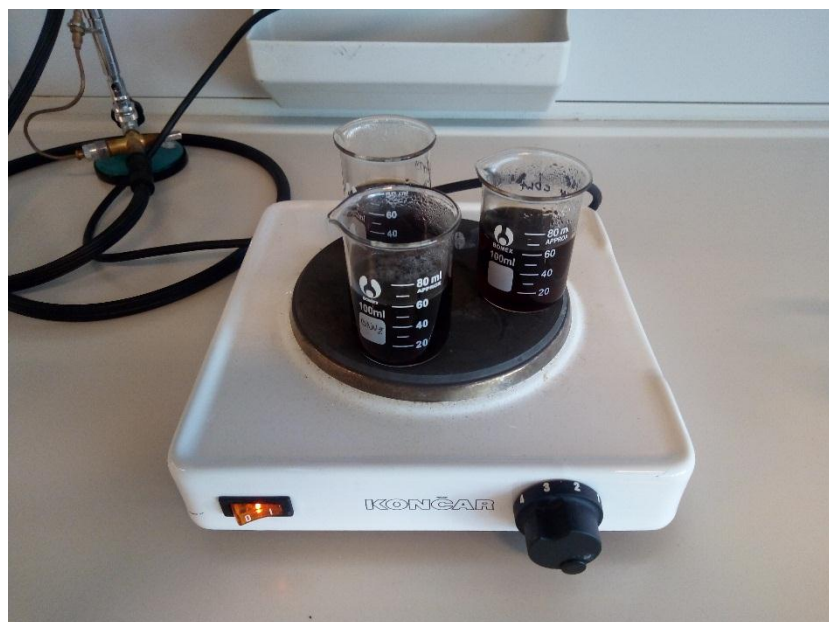
Slika 7. Uklanjanje ugljikovog dioksida iz uzoraka pića
